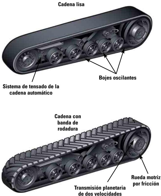
**Tren de rodaje Mobil-trac.** Mobil-trac tiene las ventajas de flotación y tracción de un tren de rodaje de cadenas y la movilidad, velocidad y calidad de desplazamiento de una extendidora de ruedas.
