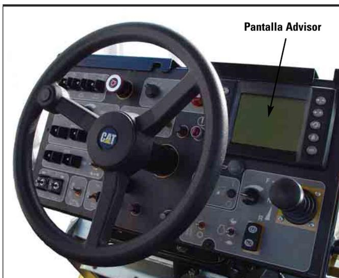
**Sistema de control Advisor (AMS).** El monitor Advisor con pantalla LCD permite acceder a la lista de actividades a realizar antes del arranque, establecer las preferencias del operador y los parámetros de funcionamiento de la máquina y el motor y acceder a la “Calculadora de Pavimentación”.
