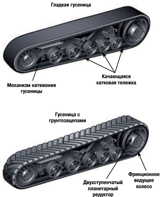
**Ходовая часть с гусеницами Mobil-trac.** Ходовая часть с гусеницами Mobil-trac сочетает тяговые свойства и проходимость гусеничного движителя с мобильностью, скоростью и ходовыми качествами колесного асфальтоукладчика.
