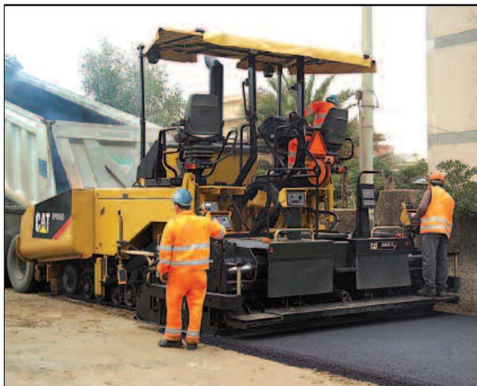
Разравнивающий брус AS4251C с диапазоном ширины укладки от 2550 мм до 5000 мм. С обеих сторон к разравнивающему брусу могут присоединяться неподвижные дополнительные секции, увеличивая ширину полосы укладки до 8000 мм.
