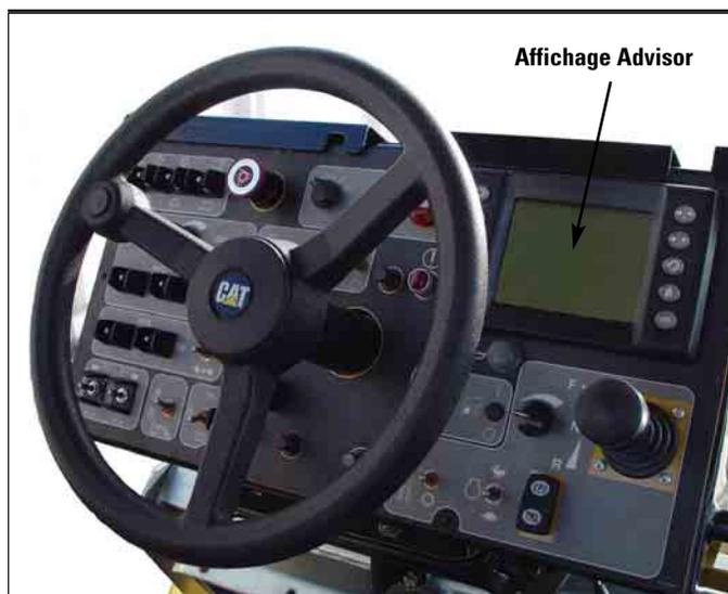
**Centrale de surveillance Advisor (AMS).** L'écran LCD Advisor donne accès à une liste de contrôles au démarrage, aux préférences du conducteur, aux paramètres de fonctionnement du moteur et de la machine ainsi qu'au "Paving Calculator" (calculateur de pose).
