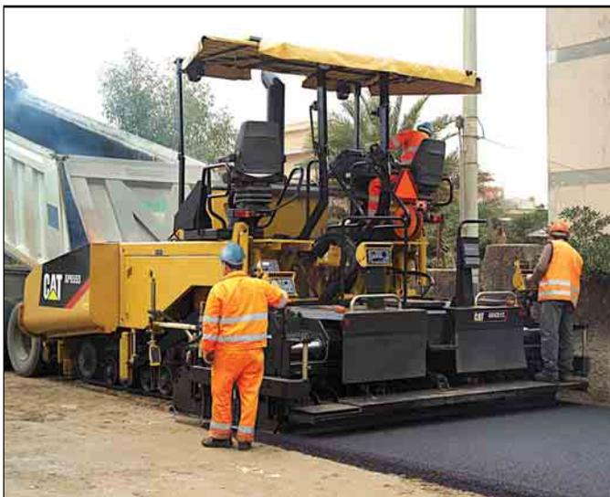
*L'AS4251C offre une largeur de pose comprise entre 2550 mm et 5000 mm. Le montage d'extensions mécaniques aux deux extrémités de la table permet d'atteindre une largeur de pose maximum de 8000 mm.*
