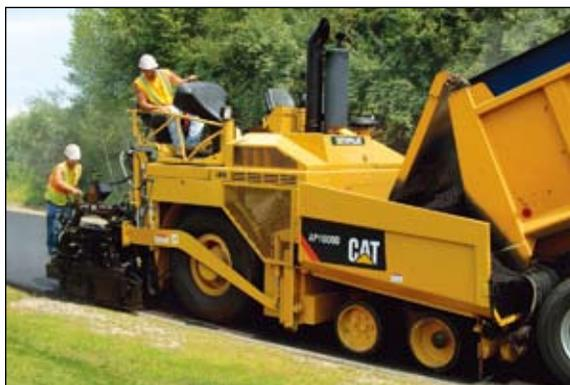
**Pavimentadora de Asfalto AP1000D (Rodas)**
