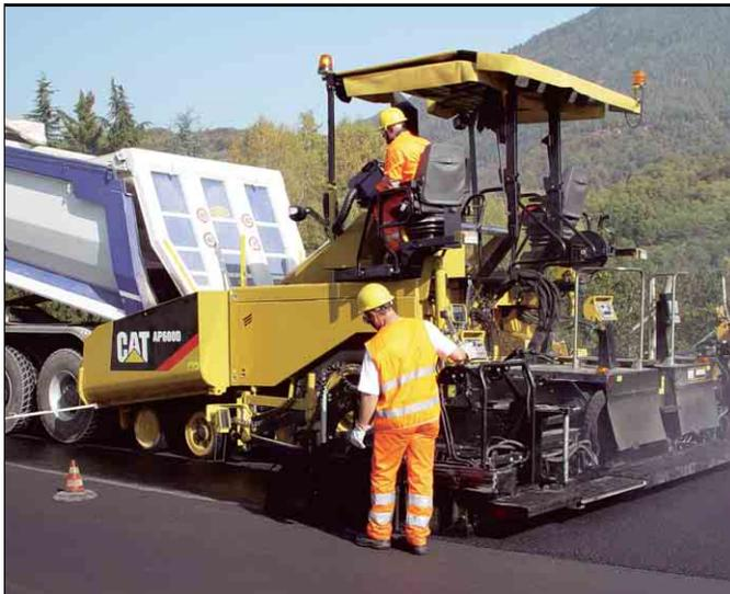
El renglón AS4251C pavimenta de 2.550 mm a 5.000 mm. Con extensiones mecánicas añadidas a ambos lados, la anchura máxima de pavimentación es de 7.000 mm (renglones de calentamiento por electricidad y por gas a baja presión).
