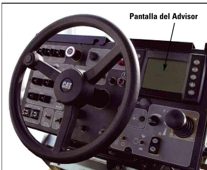
**Sistema de control Advisor (AMS).** La pantalla de cristal líquido del sistema Advisor proporciona acceso a una lista de comprobación para el arranque, a las preferencias del operador, a los parámetros operativos del motor y la máquina y a una «calculadora de pavimentación».
