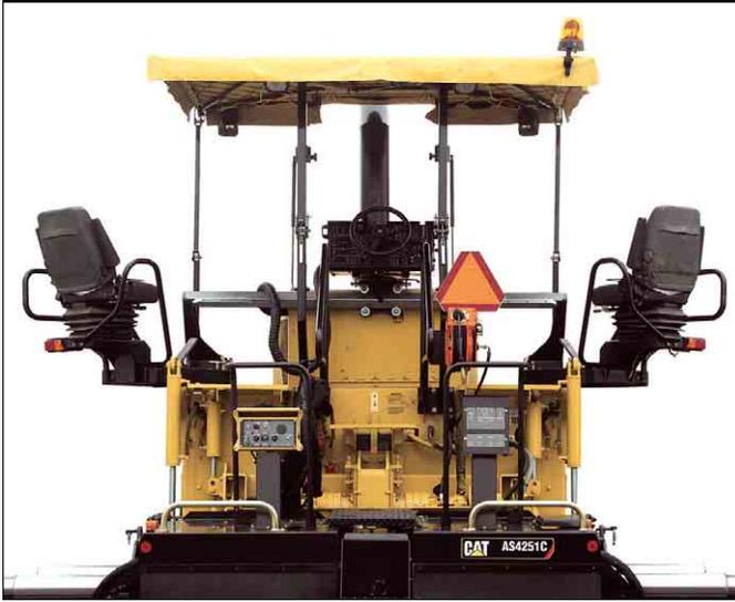
**Doble puesto de conducción.** El ergonómico doble puesto de conducción incorpora una consola de control deslizante, indicadores de la velocidad de desplazamiento sobre el suelo, asientos de suspensión ajustable, apoyabrazos y cinturones de seguridad retráctiles.
