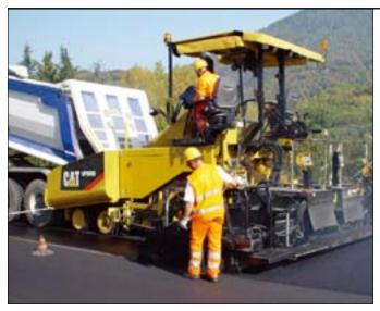
AS4251C 熨平板的摊铺范围为 2550 mm 至 5000 mm。两侧加装机械式加长板后,最大摊铺宽度可达 7000 mm(电子加热和液化气加热熨平板)。
