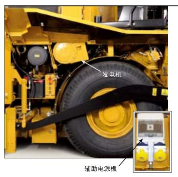
工业用单相交流发电机。摊铺机车载发电机可为熨平板电动加热装置和辅助电源板提供 60 Hz、25 kW 的电力。断路器保护、内部电压调节以及双轴承设计使机器稳定可靠。
