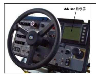
Advisor 监控系统 (AMS)。通过 Advisor 液晶显示屏可访问 启动核对清单、操作员参数选择、发动机和机器操作参数 以及"摊铺计算器"。
