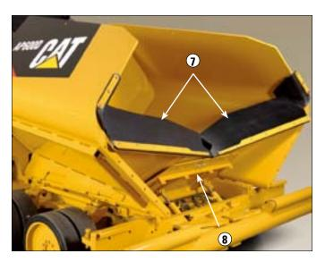
精确输送混合料。物料输送系统可精确输送混合料,尽可 能减少了操作员监控。左右刮板送料器和左右螺旋布料器 均采用独立控制。
