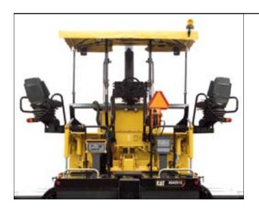
**双操作台**。符合人机工程学的双操作台采用滑移控制台、 地面速度指示器、可调节悬浮座椅、座位扶手和可伸缩座 椅安全带。
