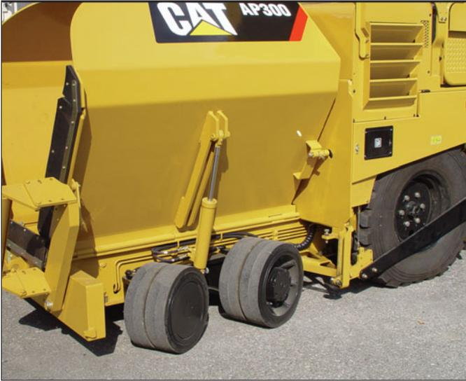
**Trator com Rodas.** A AP300 incorpora dois pneus com acionamento de grande banda de rodagem para propulsionar a máquina e quatro rodas de rolete oscilante de direção dianteira. As quatro rodas de rolete oscilante de direção de borracha sólida dianteira são montadas nos balancins do eixo oscilante dianteiro para permitir o máximo contato com o solo e uma operação suave em pontos altos e baixos.
