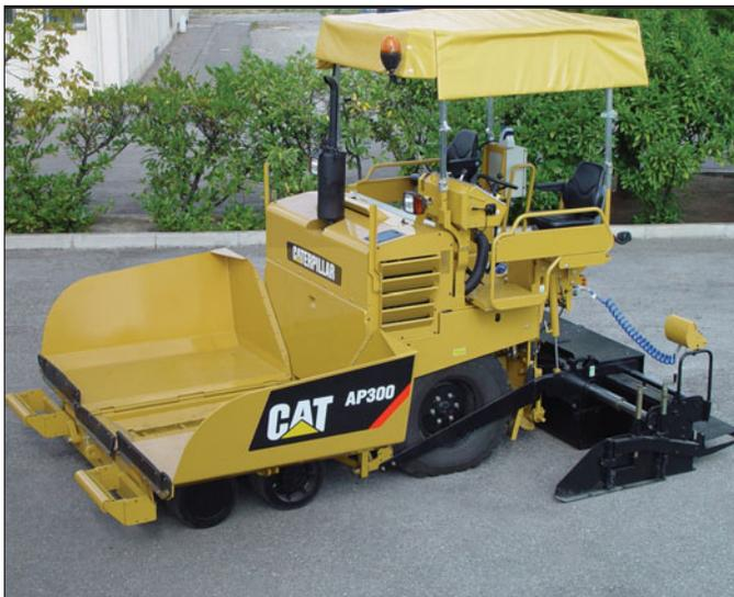
**Sistema de Propulsão Hidrostática de Ciclo Fechado.** Permite o controle preciso da propulsão e da operação de baixa manutenção.
