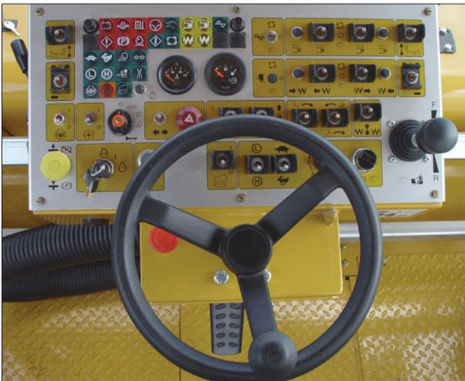
**Posto Duplo do Operador.** O posto duplo ergonômico do operador incorpora um console de controle deslizante e dois assentos com suspensão ajustável instalados em semiplataformas com deslizamento mecânico.
