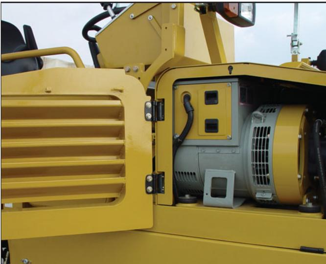
**Gerador CA Monofásico Industrial.** O gerador interno opcional fornece potência simultânea para os elementos de aquecimento da mesa elétrica, para as luzes auxiliares e para as ferramentas de local de trabalho. O gerador fornece uma saída de 12 kW para acionar o aquecimento da mesa, 220 V para o sistema de iluminação noturna e 1,5 kW para a fonte de alimentação de instalação elétrica.
