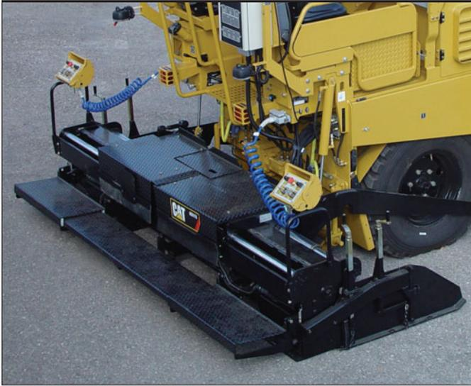
*A mesa AS3173 pavimenta de 1.700 mm a 3.200 mm. Com as extensões mecânicas incluídas nas duas laterais, a largura máxima de pavimentação é de 4.000 mm.*
