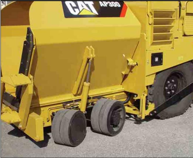
**Unidad tractora de ruedas.** La extendedora AP300 está propulsada por dos grandes neumáticos motrices con banda de rodadura con dibujo y cuatro ruedas de dirección delanteras de goma maciza montadas sobre bojes. Estas últimas están montadas a los balancines del eje oscilante delantero para máximo contacto con el suelo y un desplazamiento más suave sobre las zonas hundidas o sobreelevadas .
