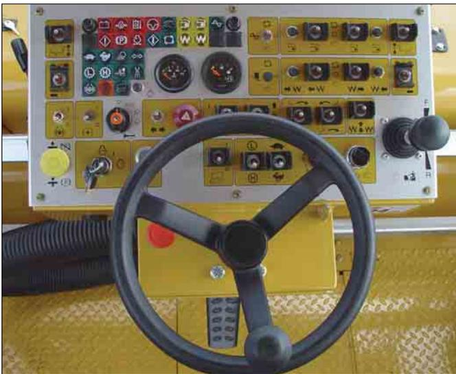
**Doble puesto de conducción.** El doble puesto de conducción del operador, ergonómico, está equipado con una consola de mando deslizante y dos asientos con suspensión ajustable montados sobre semiplataformas que se deslizan mecánicamente.
