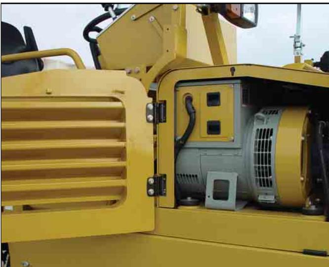
**Generador monofásico de C. A. .** El generador exterior, opcional, proporciona corriente eléctrica a los elementos de caldeo del reglón eléctrico, alumbrado y herramientas de trabajo, simultáneamente. El generador proporciona 12 kW para el calentamiento del reglón, 220 V para el sistema de alumbrado nocturno y 1,5 kW para la alimentación de otros equipos eléctricos.
