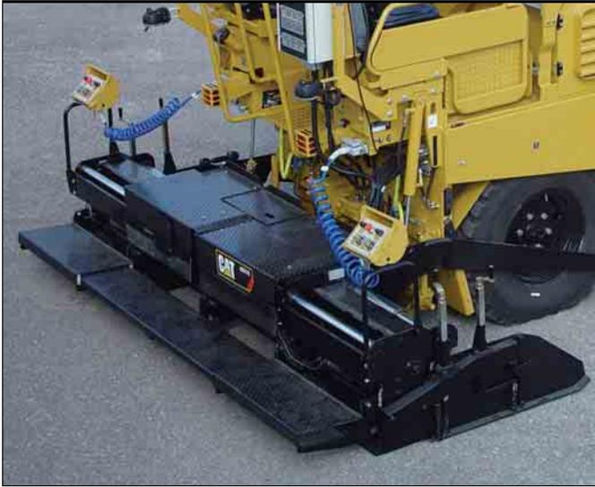
*La anchura de pavimentación del reglón AS3173 es de 1700 a 3200 mm. Equipado con extensiones mecánicas en sus dos lados, puede llegar a proporcionar una anchura de pavimentación máxima de 4000 mm.*
