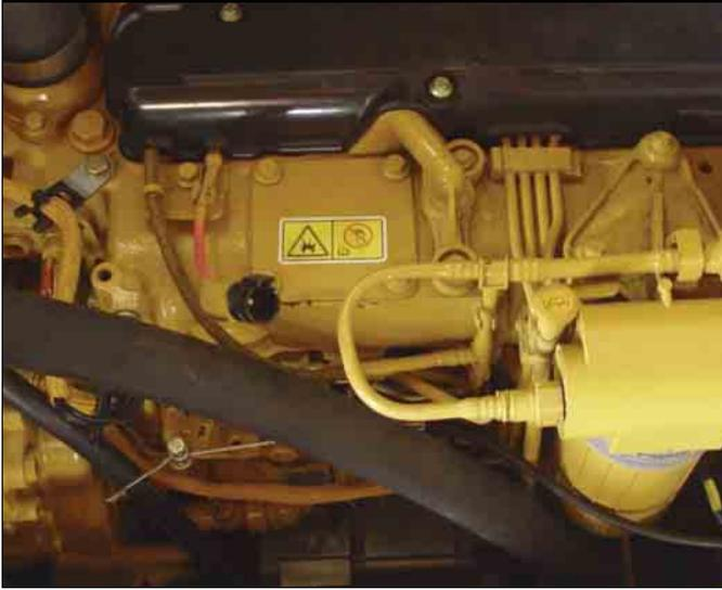
**Motor Cat 3054C DINA.** El motor 3054C proporciona una potencia bruta máxima (SAE J1995) de 52 kW (71 hp) a 2200 rev/min. El motor cumple la normativa sobre emisiones exigida durante la fase II por la UE.
