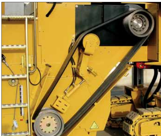
1 Övre remskiva 2 Spänningscylinder 3 Gjuten drivrem 4 Nedre remskiva 5 Ingående remskiveaxel
