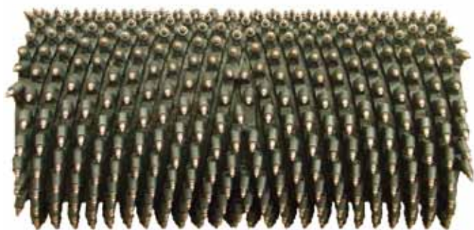
Ytfräsningsvals med 6 mm verktygsmellanrum och svetsade verktygshållare.
