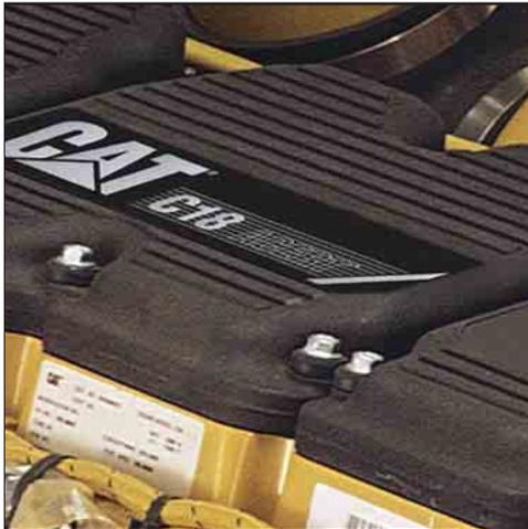
**ACERT-Konzept.** Der Cat Sechszylinder-Dieselmotor C18 mit 18,1 l Hubraum, elektronisch gesteuertes Hochdruck-Direkteinspritzung und obenliegender Nockenwelle gibt in der PM200 eine Nennleistung (ISO 9249) von 415 kW ab. Bei der Entwicklung des Motors kam das zukunftsorientierte ACERT-Konzept zur Anwendung, das auf eine Optimierung der Kraftstoffverbrennung abzielt und eine drastische Schadstoffminderung bewirkt. Dank ACERT unterschreitet der C18 die Abgasemissions-Grenzwerte der Stufe IIIA.
