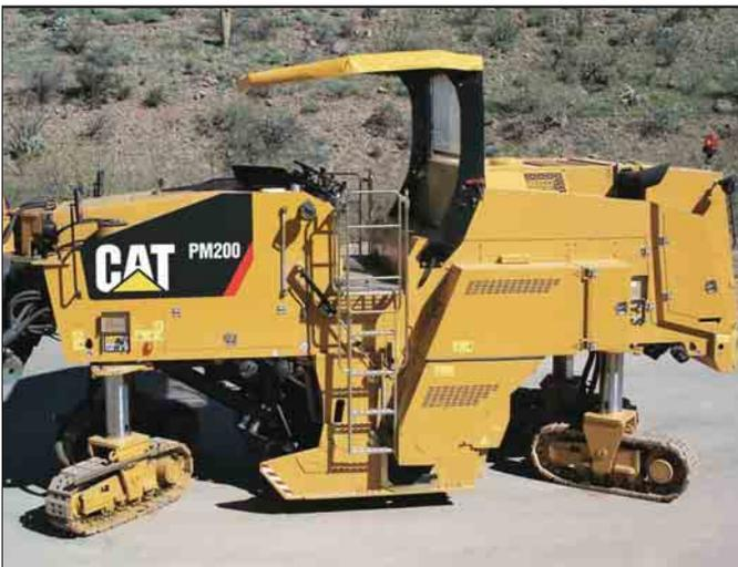
**Lenkungsarten.** Zum problemlosen Manövrieren in allen Einsatzsituationen stehen dem Fahrer Vorderketten-, Hinterketten-, Allketten- und Hundeganglenkung zur Verfügung.
