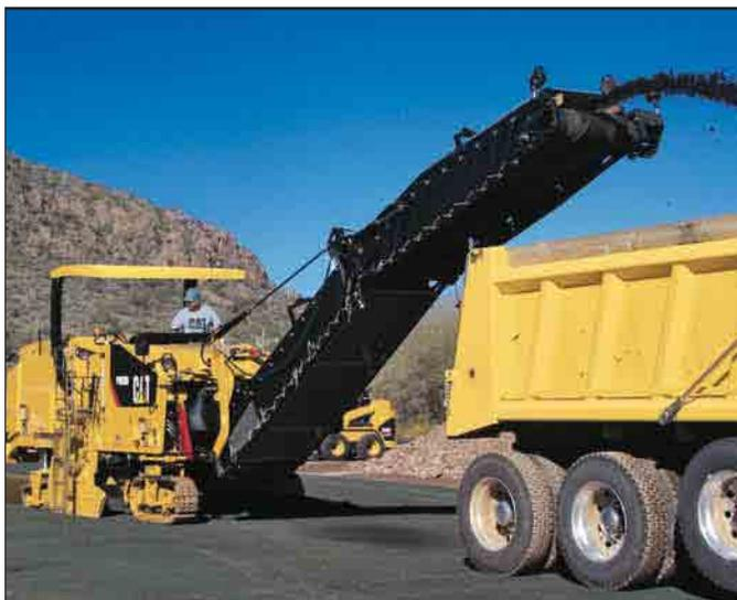
**Ladeband.** Weil sich das Ladeband hydraulisch nach hinten knicken lässt, wird die Maschinenlänge drastisch verkürzt, um den Transport zu erleichtern.
