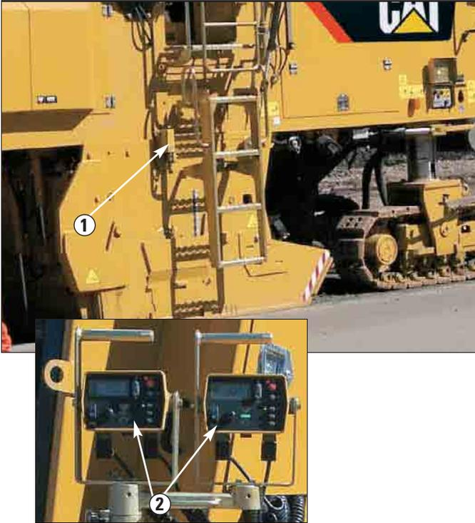
**Sensoren.** Auf beiden Seiten der Maschinen können wahlweise mechanische oder berührungslose Sensoren zur Regelung von Längs- und Querneigung installiert werden.
