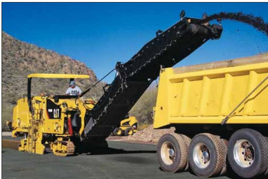
**Esteira hidráulica dobrável.** A esteira hidráulica dobrável facilita o transporte da máquina reduzindo suas dimensões.
