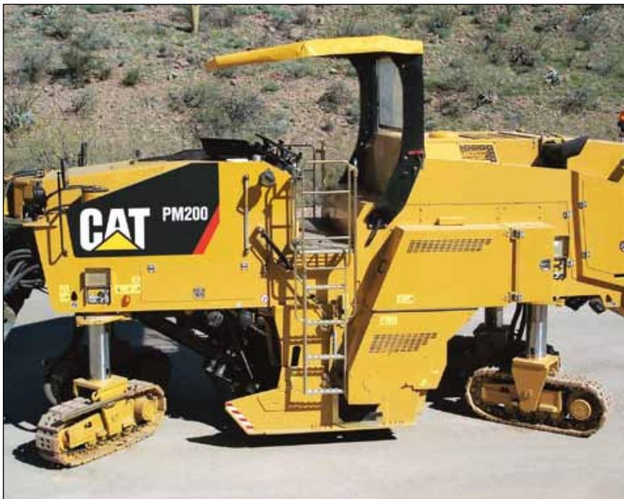
**Quatro modos de direção.** O controle de direção oferece quatro modos de direção para manobras em locais apertados: somente direção dianteira, direção transversal, direção coordenada e somente direção traseira.
