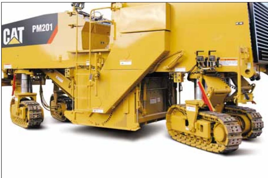
El control de dirección proporciona cuatro modalidades de dirección para maniobrar en espacios reducidos: dirección delantera únicamente, dirección acodillada, dirección coordinada y dirección trasera únicamente.
