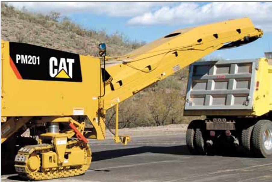
**Cuenta con un transportador superior de 915 mm (36 pulg) de ancho**, con ajuste de altura controlado hidráulicamente y dos cilindros que permiten una rotación de 45 grados hacia la izquierda y hacia la derecha.
