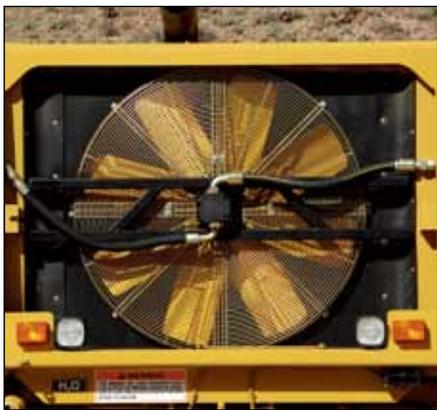
Un ventilador de enfriamiento, de velocidad variable y proporcional a la demanda, proporciona los niveles de ruido total más bajos y capacidad de operación en ambientes de altas temperaturas.
