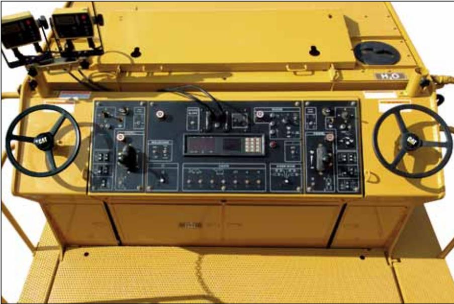
**Los controles dobles de operación** incluyen volantes de dirección, palancas de propulsión y las funciones del transportador superior, de elevación de la máquina y de dirección de la cadena trasera.
