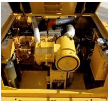
El capó del motor, impulsado con un sistema electrohidráulico, se abre completamente para proporcionar un acceso excepcional al motor, al filtro de aire, a los componentes hidráulicos y a los puntos de servicio diario.
