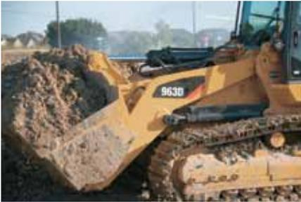
**Mandos electrohidráulicos del implemento.** Los mandos electrohidráulicos del implemento de la pala 963D proporcionan al operador un control sensible, suave y preciso del cucharón y de los brazos de elevación. También permitirán que el operador establezca sus parámetros personales mediante el sistema Messenger tales como las reacciones de los implementos.
