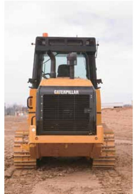
**Ubicación del motor en la parte trasera.** La ubicación del motor en la parte trasera permite una excelente visibilidad en la parte delantera, además de servir como contrapeso activo. También contribuye a reducir la obstrucción del radiador, al tiempo que facilita el acceso al motor y a otros componentes importantes para realizar tareas de mantenimiento.
