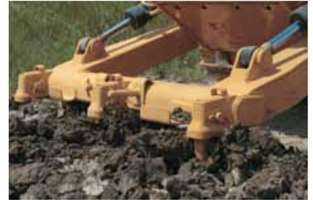
**Ripper-escarificador.** La pala 963D dispone de un ripper-escarificador radial como accesorio. Está montado con dos bulones prensados a cada lado del bastidor principal. Dos cilindros suben y bajan el ripper. La viga del ripper cuenta con tres portavástagos. Los bulones del varillaje no necesitan lubricación.
