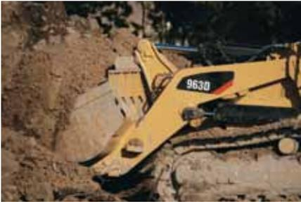
**Cucharón de uso general.** El cucharón de uso general (GP) se ha diseñado para tener una excelente capacidad de carga y una larga vida útil en una amplia variedad de aplicaciones como la excavación de banco duro, desmonte y carga de materiales amontonados. La estructura del cucharón en acero de baja aleación resiste las abolladuras y abrasiones. El borde trasero del cucharón se ha diseñado para mejorar la eficiencia en labores de enrase.
