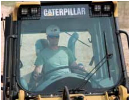
**Campo de visión.** Las ventanillas grandes utilizan lunas tintadas para reducir los reflejos y proporcionar una excelente visibilidad del cucharón, las cadenas y alrededor del capó del motor hasta la parte trasera.
