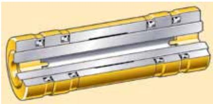
**Juntas de cartucho.** Las juntas de cartucho selladas en fábrica están soldadas para controlar el huelgo longitudinal. Ofrecen una mayor integridad del sello gracias a un nuevo e innovador sistema de sellado y no dependen de la interconexión de los eslabones para permanecer selladas. Este producto, como todos los nuevos productos para trenes de rodaje Cat, está lleno de aceites especiales.
