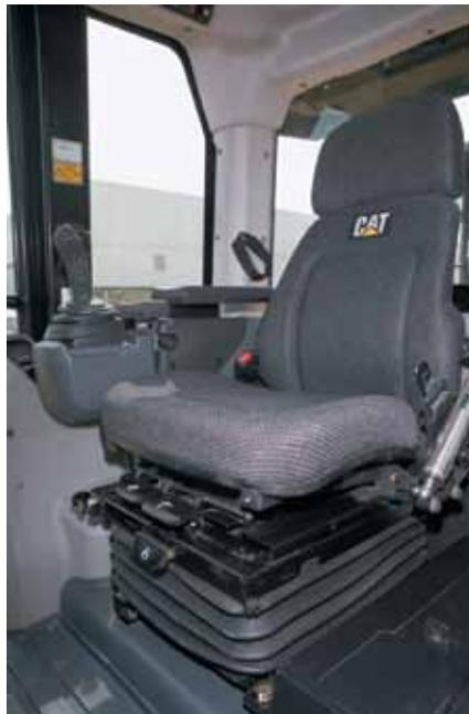
**Asiento Caterpillar con suspensión neumática.** El asiento con suspensión neumática de Caterpillar y aislamiento a ambos lados tiene un diseño ergonómico y es totalmente adaptable para proporcionar al operador la mayor comodidad y control posibles. El cinturón de seguridad enrollable mide 75 mm (3 pulg.) de ancho y proporciona una sujeción firme y cómoda.
