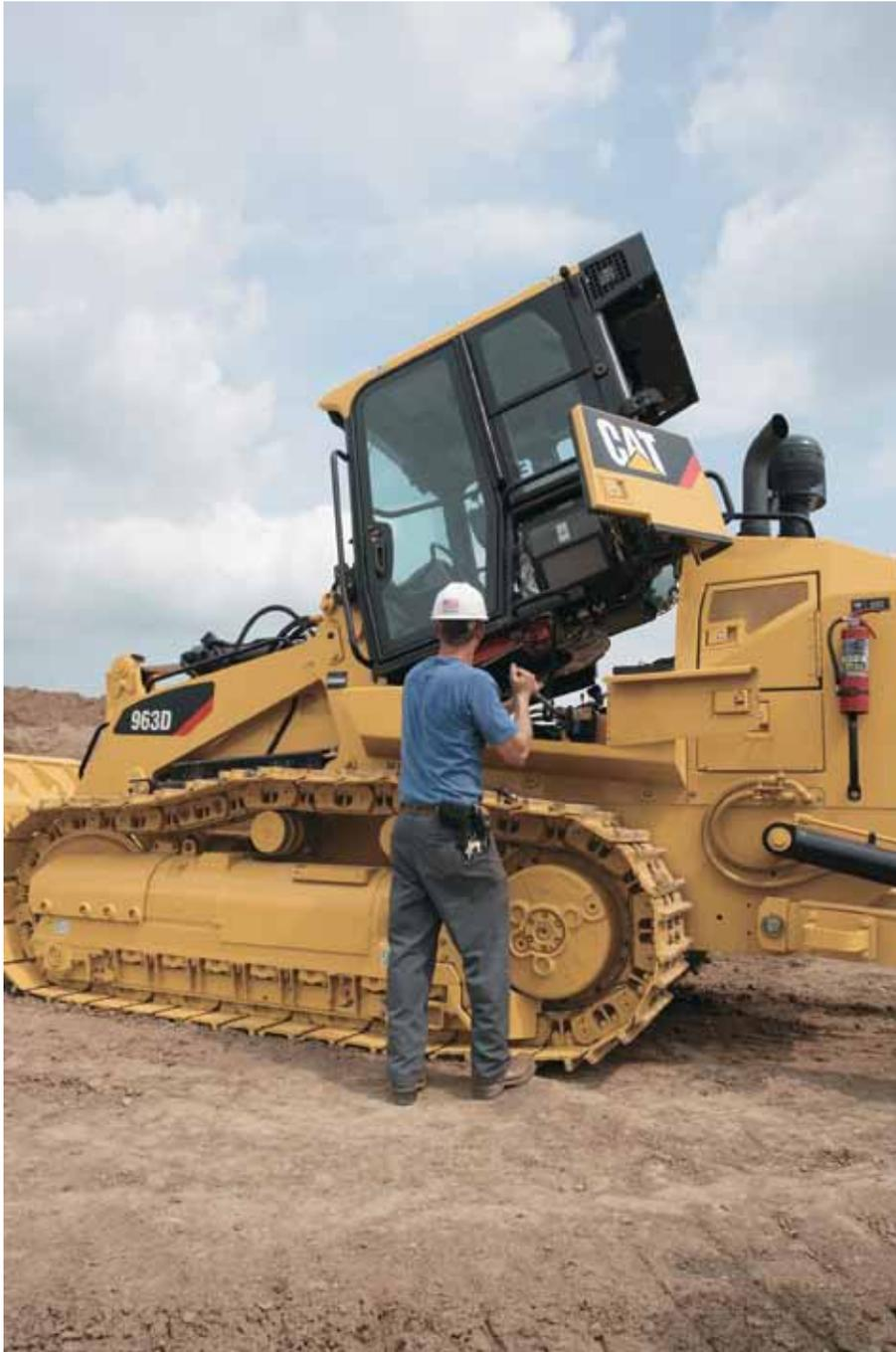
**Cabina inclinable.** La pala 963D está equipada con una cabina inclinable. Esta nueva característica facilita los trabajos de mantenimiento y reparación. Al inclinar la cabina puede acceder al tren de potencia y realizar un mantenimiento completo del sistema hidráulico.
