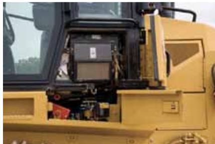
**Filtro de aire de la cabina.** El filtro de aire de la cabina, las conexiones de comprobación rápida agrupadas, la barra de bloqueo de inclinación de la cabina, el cilindro de vuelco de la cabina opcional y la caja de herramientas están convenientemente ubicados bajo la ventanilla izquierda de la cabina.
