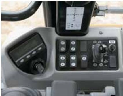
**Sistema de arranque.** El interruptor eléctrico de velocidad (A), un interruptor ubicado en la consola derecha, establece el régimen del motor. El controlador del motor ADEM A4 siempre arranca el motor al ralentí. El régimen del motor se puede ver en la pantalla digital del tablero de instrumentos situado en el panel de indicadores o en el menú de rendimiento del Messenger.
