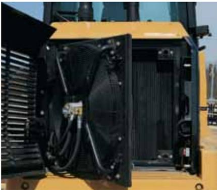
**Sistema de refrigeración.** El ventilador y la rejilla basculante cuentan con un acceso excelente para su limpieza y mantenimiento. La rejilla de servicio pesado con cerrojo reduce al mínimo la acumulación de desechos.
