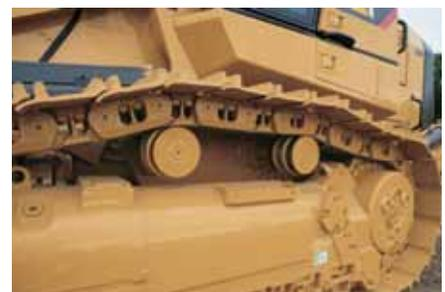
**Rodillos superiores.** La pala 963D tiene seis rodillos de cadenas, que reparten el peso de la máquina sobre un área más amplia, y dos rodillos superiores montados sobre el bastidor principal a cada lado de la máquina.
