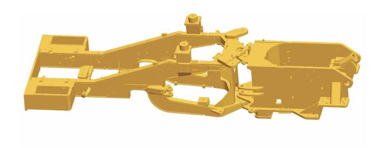
结构建造。814F系列2型有90%的部分采用了自动焊接技术,并在多处使用了铸造件,这有助于分散负载、减少零件数量,从而提高了整体强度。这种工艺提供高度一致的焊缝,同时可深穿钢板并具有出色的钢板熔接性。其优点是可提高机器的耐用性和抗疲劳强度。计算机控制的加工技术确保了销孔、轮轴垫、驾驶室支座与变速箱/发动机部件的精确定位。
