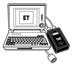
Cat 电子技师(ET)。这是一个软件程序,可让维修技师发现并确定机器问题,以及分析如何快速解决问题。使用 Cat ET,可以通过个人计算机访问电子控制模块。
