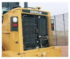
**铰接式液压油冷却器和空调冷凝器**。 采用了外摆式设计,无需专门工具即可打开,便于轻松快捷地清洁冷却 系统。
