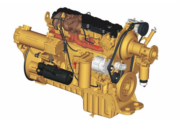
Cat® C9 ACERT 发动机。额定转速为2100 rpm,飞轮功率为173 kW(232 hp),符合美国环境保护署Tier 3 排放法规和Stage IIIA欧盟指令/97/68/EC。具有高马力、低排量,该创新型发动机具有出色的燃油经济性以及耐久性,从而可以大幅降低运营成本。
