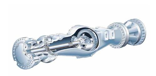
**前轮轴**。牢固安装在车架上以支撑压 实机的重量,以及压实和推土 作业时 的内部扭矩负载和外部负载。
