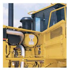
右侧检修门。便于检修发动机罩下方的各个器件,包括燃油滤清器和水分离器、燃油起动加油器以及发动机机油油尺。
