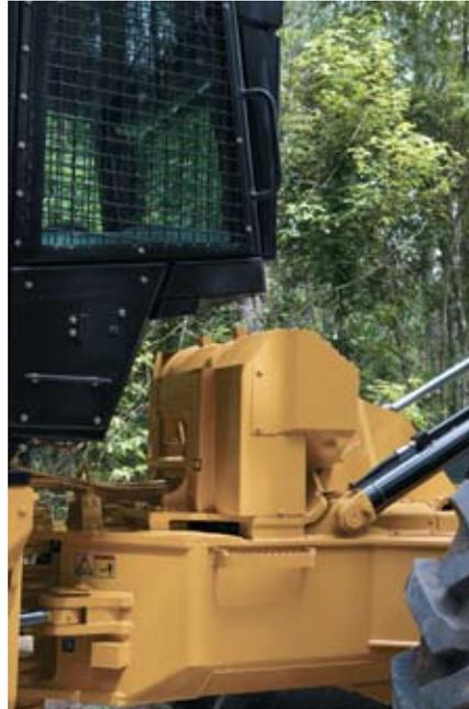
**Cabrestante hidráulico.** El modelo 545C cuenta con un cabrestante hidráulico controlado electrónicamente para aplicaciones con garfios, el cual reemplaza el cabrestante mecánico. El cabrestante hidráulico aumenta la flexibilidad de las aplicaciones al permitir que la fuerza de tracción se utilice mientras el cabrestante opera, y elimina el eje motriz de rotación continua.
