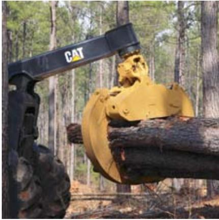
**Garfios fiables y productivos.** Los garfios diseñados y fabricados por Caterpillar utilizan una estructura de sección en caja para proporcionar la máxima durabilidad. La curvatura de las pinzas disminuye el tiempo que toma la acumulación de la carga, y las mayores fuerzas de sujeción suministran una excelente retención de la carga para su acarreo seguro al sitio de descarga.
