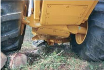
**Construcción de sección en caja.** Las estructuras de sección en caja, diseñadas y fabricadas por Caterpillar, establecen el estándar de la industria con respecto a la fiabilidad y durabilidad de los bastidores principales. El diseño del Arrastrador de Troncos 545C es el resultado de extensivos análisis computarizados y exhaustivas pruebas en el campo.
