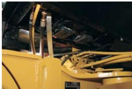
**Mangueras de enganche.** Las tuberías piloto, la tubería de presión y las tuberías de detección de carga del garfio están tendidas por encima del enganche y están dispuestas con conexiones de mampara para facilitar el reemplazo de las mangueras y agilizar el servicio. Las mangueras del enganche utilizan la tecnología Cat ToughGuard™ y tienen excelentes características de resistencia al desgaste.
