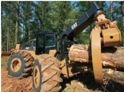
**Garfios fiables y productivos.** Los garfios diseñados y fabricados por Caterpillar utilizan una estructura de sección en caja para proporcionar la máxima durabilidad. La curvatura de las pinzas disminuye el tiempo que toma la acumulación de la carga, y las mayores fuerzas de sujeción suministran una excelente retención de la carga para su acarreo seguro al sitio de descarga.
