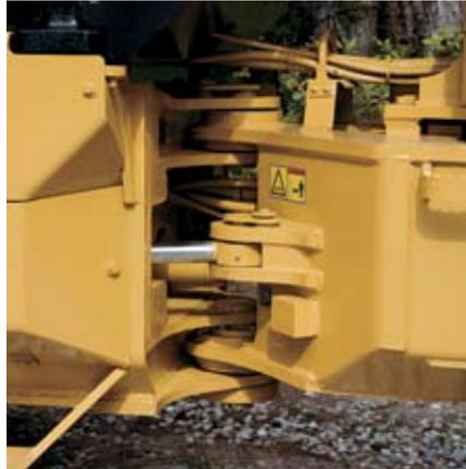
**Enganche.** Una sección central de servicio pesado cuenta con planchas y mazas de sobremedida para dispersar las fuerzas. Un cojinete de rodillos de doble chaflán se utiliza en el enganche inferior para disminuir la tensión ocasionada por la flexión y para mantener las uniones ajustadas.
