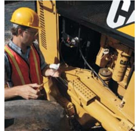
**Sistema eléctrico.** El sistema eléctrico de 24 voltios suministra energía eléctrica fiable para la puesta en marcha del motor, iluminación adicional y diagnósticos del motor. Los circuitos cableados están codificados con colores, numerados y protegidos por disyuntores.
