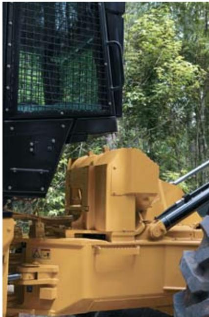
**Cabrestante hidráulico.** El modelo 525C cuenta con un cabrestante hidráulico controlado electrónicamente para aplicaciones con garfios, el cual reemplaza el cabrestante mecánico. El cabrestante hidráulico aumenta la flexibilidad de las aplicaciones al permitir que la fuerza de tracción se utilice mientras el cabrestante opera, y elimina el eje motriz de rotación continua.
