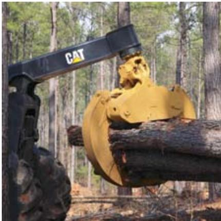
**Garras Confiáveis e Produtivas.** As garras projetadas e fabricadas pela Caterpillar utilizam seção transversal retangular (em caixa) para aumentar a durabilidade. A curvatura da pinça reduz o tempo necessário para enfiar a carga, e a maior força de fixação proporciona excelente retenção de carga, dando maior segurança no transporte até o ponto de descarga.
