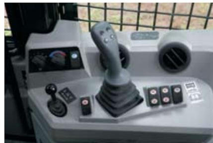
**Recurso Auto-Grab.** O Auto-Grab (agarramento automático), projetado pela Caterpillar, monitora constantemente a pressão da pinça e ajusta conforme necessário para segurar firmemente as cargas da garra durante o arrasto. Ele é facilmente ativado por comando através de um interruptor localizado na alavanca de controle da direita.
