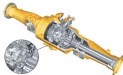
**Eixo Dianteiro.** O eixo dianteiro conta com um projeto fixado a um pinhão e um alojamento reforçado, eliminando a necessidade de proteção para o eixo dianteiro.
