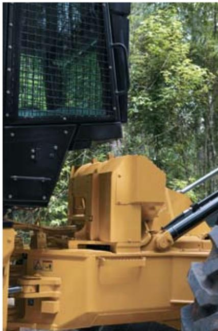
**Guincho Hidráulico.** O 545C conta com um guincho hidráulico, controlado eletronicamente, para aplicações da garra, substituindo o guincho mecânico. O guincho hidráulico melhora a flexibilidade das aplicações, permitindo que o esforço de tração seja usado durante a operação de guincho e eliminando a contínua rotação do eixo de transmissão.
