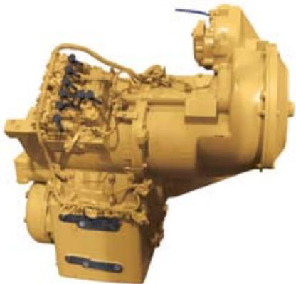
**Transmissão de Cinco Marchas.** A servotransmissão com eixo intermediário da Caterpillar, testada em campo, combina facilmente a potência do motor com o tamanho da carga e as condições de solo. O controle eletrônico possibilita o uso dos controles com as pontas dos dedos, reduzindo o cansaço do operador e aumentando o conforto.
