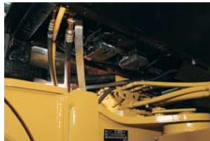
**Mangueiras do Engate.** As tubulações piloto das garras, a tubulação de pressão e as tubulações de detecção de carga passam por cima do engate e são apoiadas sobre anteparos para facilitar a substituição das mangueiras e tornar mais rápida a manutenção. As mangueiras do engate utilizam a tecnologia Caterpillar ToughGuard™ e possuem excelentes características contra o desgaste.
