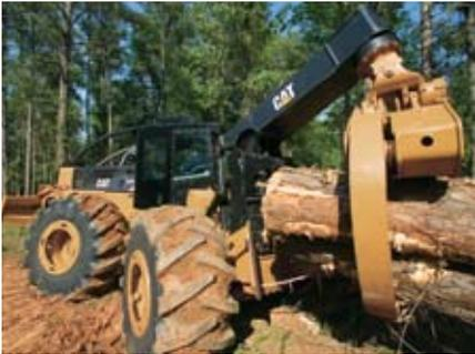
**Garras Confiáveis e Produtivas.** As garras projetadas e fabricadas pela Caterpillar utilizam seção transversal retangular (em caixa) para aumentar a durabilidade. A curvatura da pinça reduz o tempo necessário para enfiar a carga, e a maior força de fixação proporciona excelente retenção de carga, dando maior segurança no transporte até o ponto de descarga.
