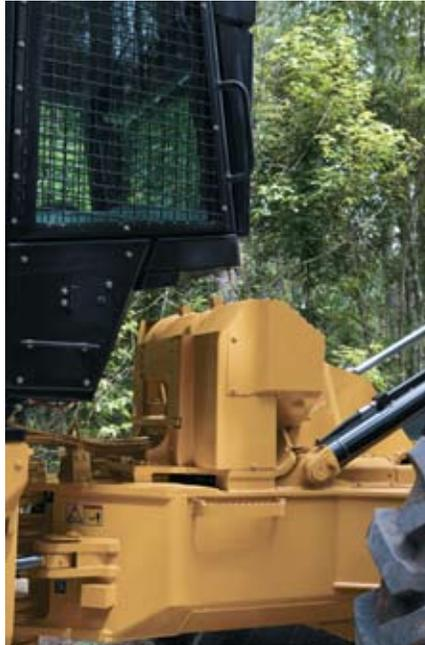
**Guincho Hidráulico.** O 525C conta com um guincho hidráulico, controlado eletronicamente, para aplicações da garra, substituindo o guincho mecânico. O guincho hidráulico melhora a flexibilidade das aplicações, permitindo que o esforço de tração seja usado durante a operação de guincho e eliminando a contínua rotação do eixo de transmissão.
