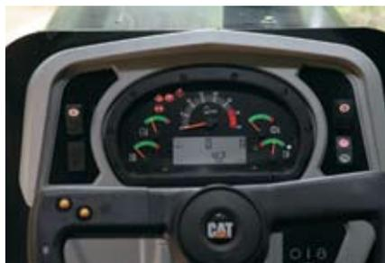
**Controles de Monitoração.** Medidores e telas, convenientemente localizados e de fácil visualização, simplificam ao máximo os sistemas de monitoramento da máquina.
