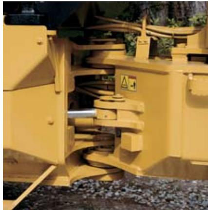
**Engate.** Sua seção central reforçada conta com placas e ressalto superdimensionados para dispersar as forças. Um rolamento de rolos maior e de cone duplo é usado no engate inferior para reduzir a tensão de flexão e manter as juntas bem vedadas.
