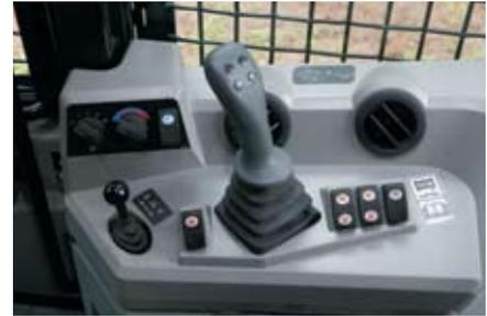
**Recurso Auto-Grab.** O Auto-Grab (agarramento automático), projetado pela Caterpillar, monitora constantemente a pressão da pinça e ajusta conforme necessário para segurar firmemente as cargas da garra durante o arrasto. Ele é facilmente ativado por comando através de um interruptor localizado na alavanca de controle da direita.
