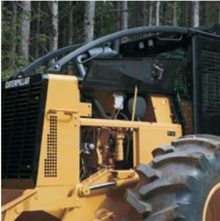
**Motor com Portas de Acesso Rápido.** O motor com portas de acesso grandes e articuladas torna a manutenção a mais fácil e rápida possível. O fácil acesso aos pontos de serviço diários aumenta a probabilidade de realização da manutenção, além de aumentar a vida útil da máquina. Além disso, menos tempo de manutenção significa mais tempo de trabalho e maior produtividade.
