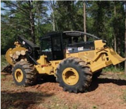
**Construção em Seção em Caixa.** As estruturas com seção transversal retangular (em caixa) projetadas e fabricadas pela Caterpillar definem o padrão de confiabilidade e durabilidade dos chassis principais usados no setor. O projeto do 525C é resultado de extensivas análises de computador e testes em campo.
