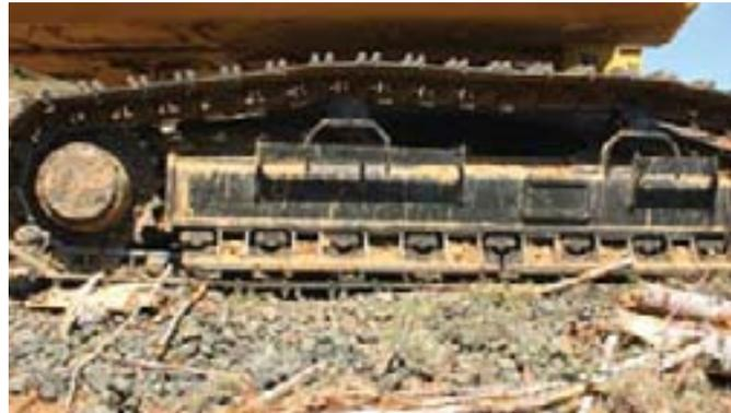
**Поддерживающие катки**, рассчитанные на тяжелые режимы эксплуатации. Для обеспечения исключительной долговечности поддерживающие ролики заменены опорными роликами с двойными упорами.
