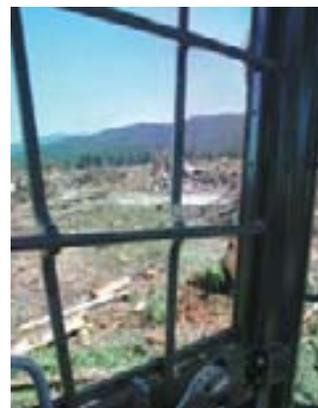
**Обзорность.** В конструкции кабины оптимально расположены стойки и ударопрочные стекла из поликарбоната, которые обеспечивают превосходный круговой обзор. Кабины машин для лесозаготовительной промышленности изготавливаются с ограждением, рассчитанным для тяжелых условий эксплуатации, и соответствующим требованиям, предъявляемым к конструкциям FOPS/OPS/FOGS/TOPS и CB.
