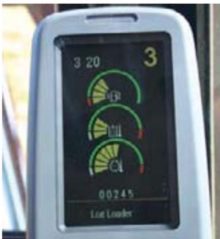
**Монитор.** В кабине установлен полноцветный жидкокристаллический графический дисплей с разрешением 400/3/234 пикселя. Угол наклона монитора может быть отрегулирован, чтобы минимизировать солнечные блики. Информация на мониторе может отображаться на одном из двадцати семи языков.
