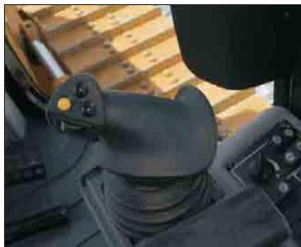
**Control de los implementos.** El tractor de cadenas D6K puede ser equipado con ripper o cabrestante. Para mayor flexibilidad, el tractor puede ser equipado con un mando para el ripper, un mando para el cabrestante o un mando que permita seleccionar el uso del ripper o del cabrestante.
