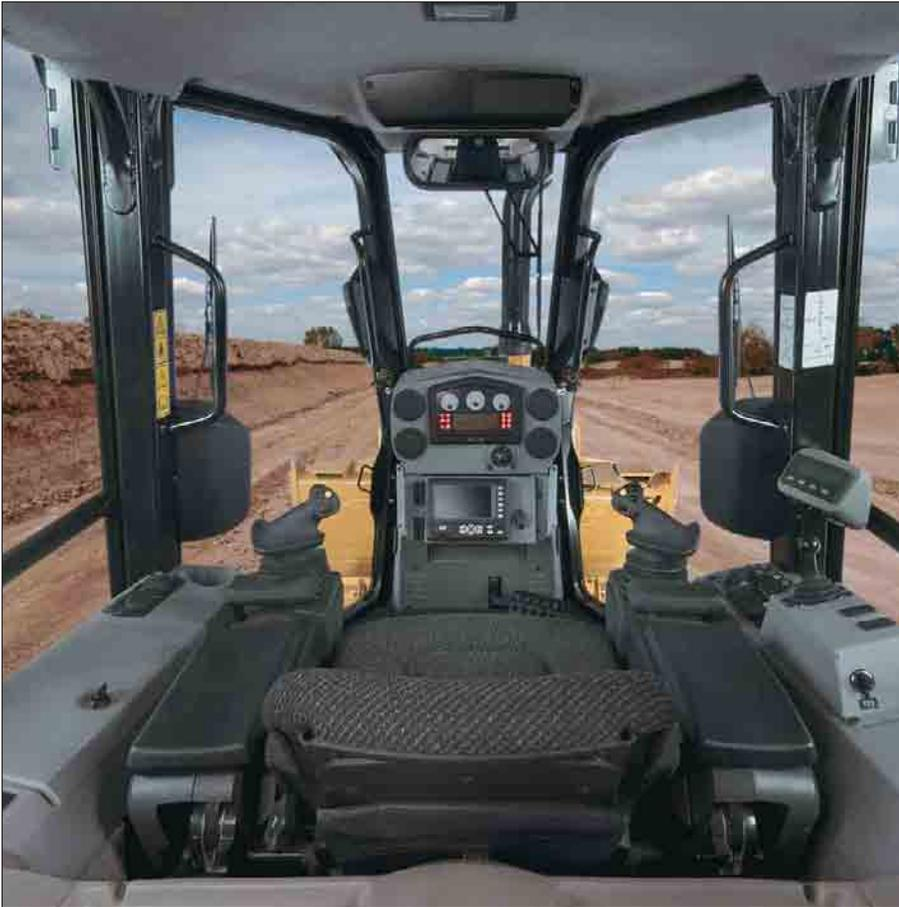
**Puesto del operador.** El puesto del operador está equipado con mandos ergonómicos diseñados para ser manejados fácil y cómodamente. El aire acondicionado de serie, la excelente visibilidad y el gran espacio para las piernas permiten al operador concentrarse en su trabajo. Y la gran superficie acristalada le permite ver la hoja y la zona de trabajo colindante.
