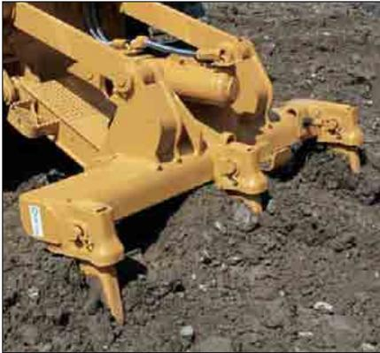
**Ripper tipo paralelogramo.** El ripper de dientes múltiples permite utilizar uno, dos o tres dientes según las condiciones de trabajo. Se dispone de dientes rectos o curvos. La gran resistencia del bastidor principal permite montar soportes de ripper más rígidos para aplicaciones severas con la barra de tiro.
