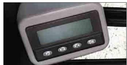
**Messenger.** Messenger es un sistema de control de la máquina en tiempo real que proporciona al operador información sobre el funcionamiento del motor y de la máquina, como rendimiento, consumo de combustible y diagnóstico, y le permite ajustar algunos parámetros como la modulación de la dirección y del implemento.
