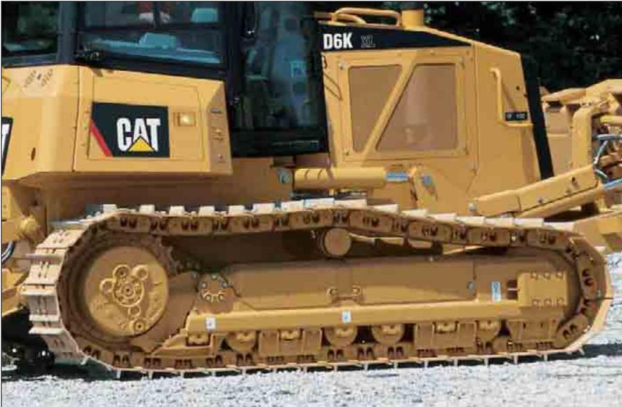
**Tren de rodaje SystemOne™.** El tren de rodaje SystemOne, exclusivo de las máquinas Caterpillar, es muy duradero y reduce espectacularmente los costes de operación y mantenimiento.
