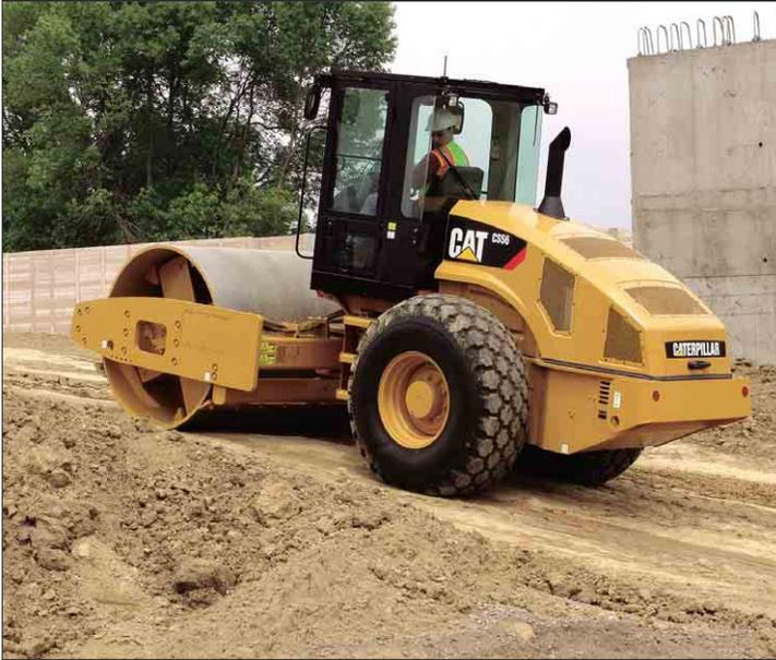
**Sistema de propulsión.** El sistema de propulsión de dos bombas, dedicadas exclusivamente a esta función, acciona los motores del tambor y de las ruedas traseras, independientemente. Si alguno de los motores comenzara a patinar, la máquina mantendría su fuerza de tracción porque siempre habrá caudal hidráulico suficiente para el motor que no patina.
