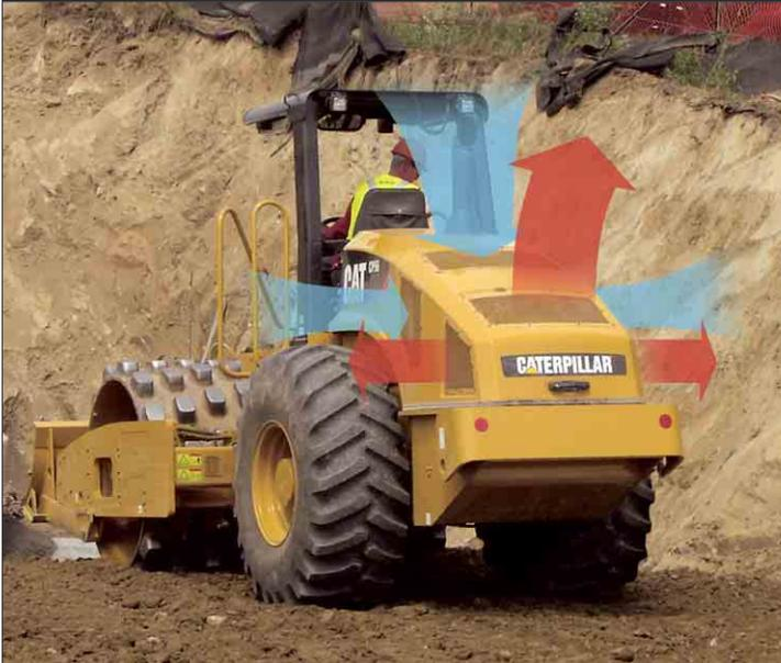
**Optimización del flujo del aire.** El aire frío entra por el centro del capó y expulsa el aire caliente hacia atrás.
