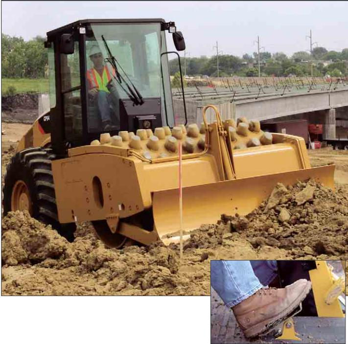
**Mayor versatilidad y utilización.** La hoja niveladora sirve para muchas aplicaciones, como desmontes, nivelación de tierras, relleno de zanjas y empuje ligero.
