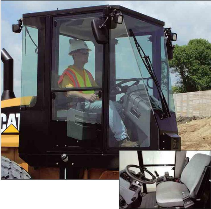
**Cabina amplia y cómoda.** La cabina de diseño ergonómico proporciona al operador un lugar de trabajo cómodo y silencioso con más espacio interior y compartimentos para guardar objetos personales. Además, la amplitud del parabrisas y ventanillas y la mayor superficie acristalada de la luneta trasera permiten al operador una visibilidad excepcional.
