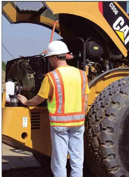
*El capó de fibra de vidrio de una sola pieza, que bascula hacia adelante, permite acceder cómodamente al motor y al sistema de refrigeración. Todos los puntos de servicio son accesibles desde el suelo y están agrupados en uno de los lados de la máquina.*
