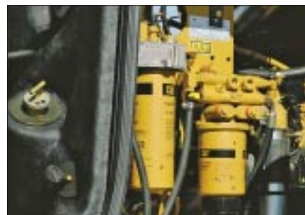
**Электрический топливоподкачивающий насос.** Электрический топливоподкачивающий насос расположен непосредственно на основании фильтра грубой очистки топлива. Такая конструкция устраняет необходимость первичной заправки фильтра топливом после замены либо ручной подкачки топлива, за счет чего снижается риск попадания инородных частиц в топливную систему.
