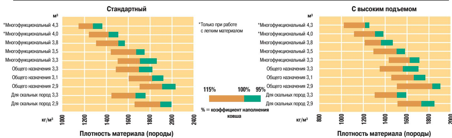
В соответствии с требованиями стандарта SAE J818, значения указаны при условии, что нагруженная масса ковша равна половине значения статической опрокидывающей нагрузки с ковшом в положении полного поворота.
