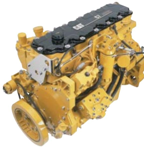
**Электронные гидравлические насос-форсунки (HEUI).** Система HEUI в течение ряда лет применяется в конструкции силовых агрегатов Caterpillar. Она отличается высокими показателями стабильности работы, долговечности и надежности.
