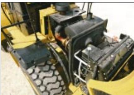
Гидроцилиндр подъема с механическим приводом и ручным управлением предусмотрен для открывания капота. Открывающийся капот обеспечивает свободный доступ к моторному отсеку. При необходимости капот можно снять полностью — для этого он оборудован специальными проушинами.
