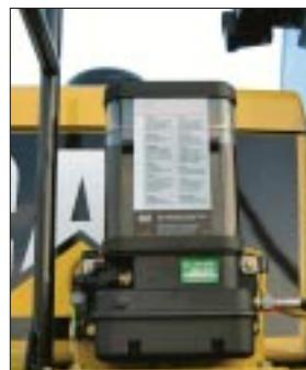
**Централизованный узел обслуживания гидравлики.** Центризованный узел обслуживания гидравлики, расположенный за правой лестницей, объединяет масляные фильтры коробки передач и гидравлической системы. Для доступа к узлу обслуживания лестница откидывается на шарнирах. Здесь же расположен порт доступа к гидравлическому баку, через который можно произвести полный слив гидравлической жидкости.
