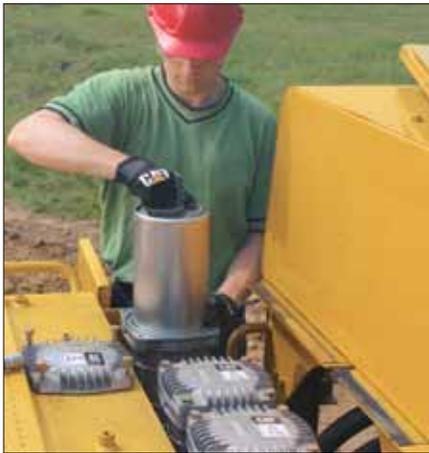
**Интервалы между техническим обслуживанием** увеличены, что позволило снизить затраты средств на его проведение. Регламентный интервал обслуживания для фильтра моторного масла, фильтра масла гидравлической системы и фильтра топлива составляет 500 моточасов.
