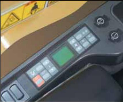
**Консоли** имеют новый, более простой и функциональный дизайн, позволяющий снизить утомляемость оператора, облегчить выбор и включение нужного переключателя и обеспечить отличную различимость каждого элемента. Обе консоли имеют приставные подлокотники, которые могут регулироваться по высоте.
