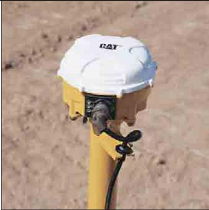
**AccuGrade GPS.** L'AccuGrade GPS elabora le informazioni di posizionamento sulla macchina, confrontando la posizione della lama in relazione al progetto e fornisce le informazioni all'operatore, tramite il display in cabina.
