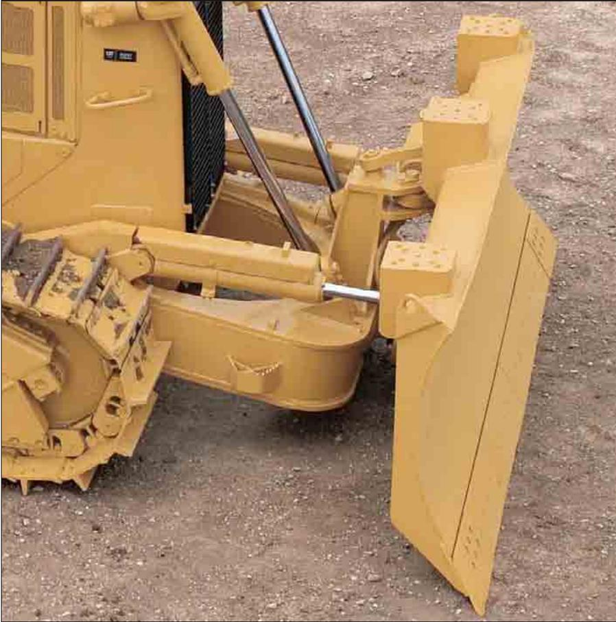
**Lame Caterpillar.** Tutte le lame sono caratterizzate da una robusta costruzione scatolare resistente alle gravose sollecitazioni flessionali e torsionali. Le lame sono realizzate in acciaio Cat DH-2™, ad elevata resistenza. La costruzione robusta della lama e l'utilizzo di salvataglianti imbullonati e terminali induriti assicura la massima affidabilità e durata.
