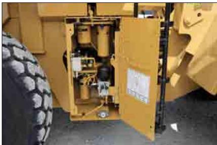
**Centro servizi idraulico.** I filtri del sistema idraulico e della trasmissione sono localizzati nel centro servizi, posto dietro la scaletta incernierata di accesso al lato destro della macchina. Il drenaggio dell'olio dal serbatoio idraulico è possibile dallo stesso centro servizi.
