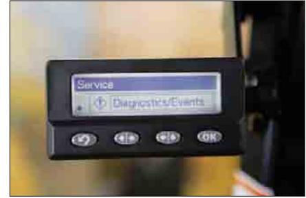
**Cat Messenger.** Il sistema di monitoraggio Messenger consente di avere, in tempo reale, indicazioni visive sul funzionamento della macchina. Esso mostra informazioni con codici diagnostici e parametri di manutenzione.
