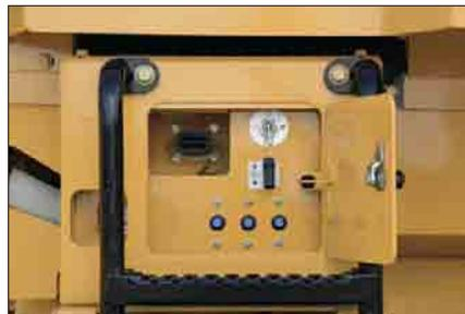
**Centro servizi elettrico.** Un secondo compartimento, sotto il lato sinistro della piattaforma d'accesso, consente di accedere a tutte le principali parti elettriche, come la presa per avviamento esterno, l'interruttore staccabatteria, il pannello fusibili e l'interruttore di azionamento per l'apertura del cofano. Le batterie, esenti da manutenzione, sono ben posizionate nella parte inferiore del centro servizi.
