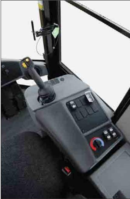
**Comandi attrezzature.** I comandi attrezzature, di nuovo disegno, con braccioli regolabili, garantiscono il massimo comfort. L'interruttore di cambio di direzione consente all'operatore di mantenere una mano sui comandi attrezzature, mentre aziona il cambio di direzione. Un joystick a richiesta, con interruttore di cambio direzione integrato, è disponibile in sostituzione alle due leve di sollevamento e richiamo.
