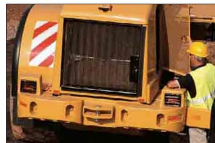
**Contrappeso.** Il contrappeso in due sezioni è integrato nel disegno della 938H e garantisce una protezione addizionale alle luci inserite nella parte superiore.
