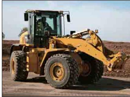
**Sistema di sterzo.** Il sistema di sterzo load sensing assorbe potenza soltanto quando richiesto. La nuova pompa manuale di sterzo e la valvola di priorità assicurano all'operatore il totale azionamento dello sterzo e la capacità di movimenti simultanei anche a basso numero di giri. La colonna di sterzo con il pannello strumenti è inclinabile, per un maggior comfort.
