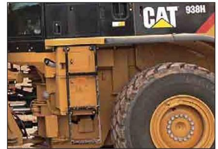
**Entrata ed uscita.** Una scaletta con materiale antiscivolo riduce al minimo l'accumulo di detriti; la scaletta è inclinata di 5° in avanti per facilitare entrata ed uscita.
