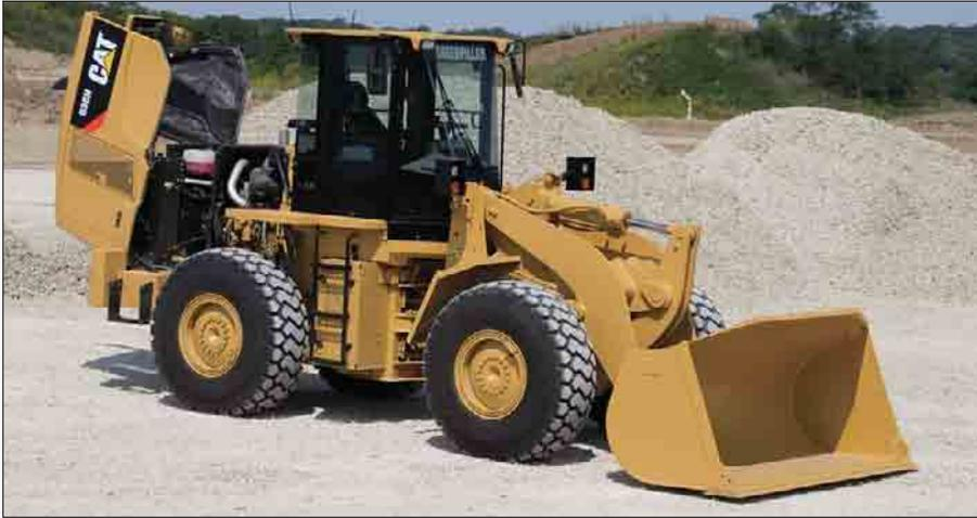
**Accesso al vano motore.** Un semplice cilindro di sollevamento ad azionamento elettroidraulico e back-up meccanico, solleva il cofano motore. Il cofano apribile
