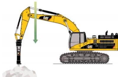
**Applicazioni con martello.** Lo SmartBoom è facile da usare ed aumenta la produttività in applicazioni con martello, in quanto il braccio segue automaticamente il martello mentre questo avanza nella roccia. I colpi a vuoto o l'eccessivo carico sul martello sono evitati, assicurando così una maggiore durata a martello e macchina. Vantaggi simili si riscontrano anche con le piastre vibranti.
