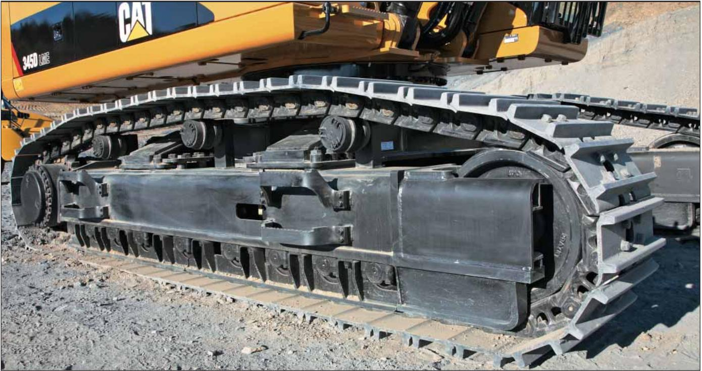
**Opzioni carro.** Carro con catenarie lubrificate a grasso. Le catenarie sono assemblate con grasso e sigillate per ridurre le usure e la rumorosità, a tutto vantaggio dei costi operativi. A richiesta, sono disponibile le catenarie HD con sistema di tenuta "Positive Pin Retention 2" (PPR2) e le ruote folli in fusione.
