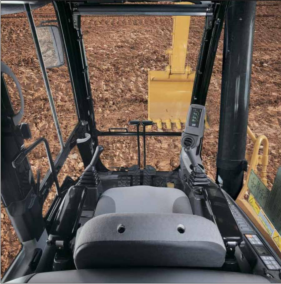
**Disegno.** La cabina, spaziosa e confortevole, assicura il massimo comfort e la massima produttività. I comandi del climatizzatore automatico e delle attrezzature sono convenientemente posizionati sul lato sinistro, mentre la chiave d'avviamento e l'acceleratore sono sul lato destro. Il monitor è ben visibile e di facile lettura.
