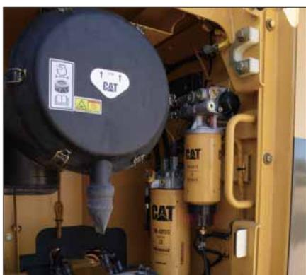
**Separatore acqua/combustibile.** Il separatore acqua-combustibile ha un filtro primario ed è alloggiato nel vano batteria, facilmente accessibile da terra.
