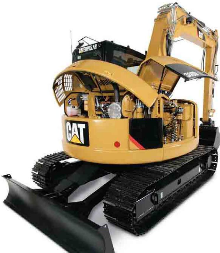
Robustezza, affidabilità e facilità di manutenzione sono i punti chiave del successo degli escavatori idraulici Cat. Pannelli di lavoro in acciaio garantiscono una lunga durata. Tutti i punti di manutenzione giornaliera sono facilmente accessibili dal cofano posteriore e dai pannelli laterali; l'intervallo di sostituzione motore a 500 ore contribuisce a ridurre i costi operativi. Le prese A•P•L facilitano i prelievi di olio per i controlli preventivi.
