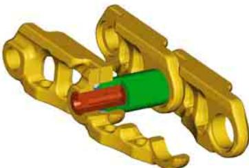
**Carro.** Il carro del 385C L ha le catenarie lubrificate a grasso GLT4. Le catenarie sono assemblate con grasso e sigillate per ridurre le usure e la rumorosità, a tutto vantaggio dei costi operativi.
