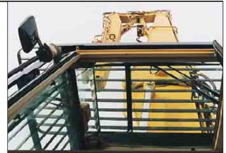
**Protezione FOG.** La struttura di protezione conforme alle norme ISO 10262-1998, contro la caduta di oggetti, è standard. Le barre trasversali della protezione superiore sono angolate in modo da non interferire con la visibilità sull'attrezzatura. La protezione anteriore ruota verso l'esterno per agevolare la pulizia del parabrezza.
