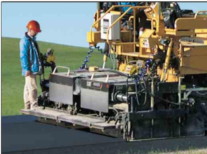
**Rasatore produttivo.** Il rasatore AS4251 è caratterizzato da una doppia larghezza di stesa standard, da 2,55 m a 5,00 m. Il rasatore, combinato con la vibrofinitrice Cat, offre un'eccellente manovrabilità ed un'avanzata tecnologia che rende il complesso ideale per la stesa di manti bituminosi dove sia richiesta la massima flessibilità, con frequenti cambi di larghezza di stesa.
