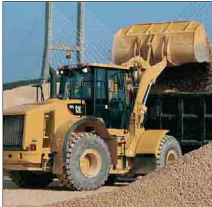
I fine corsa automatici, regolabili dal posto di guida, contribuiscono ad una maggiore flessibilità e produttività, ottimizzando il carico su mezzi di diversa altezza. I fine corsa di richiamo, sollevamento e ritorno allo scavo sono facilmente regolabili con un interruttore in cabina.
