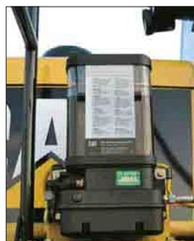
**Centro di servizio idraulico.** I filtri del sistema idraulico e della trasmissione sono centralizzati in un punto di servizio, dietro la scaletta d'accesso incernierata. Il serbatoio dell'olio idraulico è provvisto di un sistema di drenaggio.
