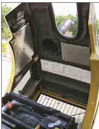
**Accesso al vano motore.** Il cofano non metallico della 962H è stato ridisegnato; i pannelli laterali e superiore sono più robusti, grazie a costole di rinforzo ed alla nuova curvatura.
