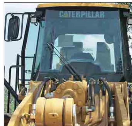
**Cabina.** L'intera cabina può essere rimossa in circa 45 minuti ed è predisposta per un rapido rimontaggio; sono utilizzati attacchi rapidi per consentire il collegamento delle cablature elettriche e delle tubazioni del refrigerante dell'aria condizionata.
