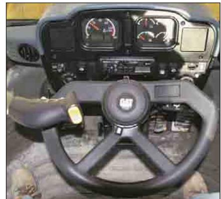
La completa articolazione del telaio è possibile con una rotazione di  $\pm 70^\circ$  del volantino, in paragone ai  $360^\circ$  del sistema tradizionale. Il CCS include i comandi di trasmissione e due interruttori, integrati ergonomicamente, uno per il cambio di marcia e l'altro per il cambio di direzione; in tal modo l'operatore può azionare la trasmissione soltanto con la mano sinistra. La colonna di sterzo (CCS) è telescopica (fino a 100 mm) e si inclina di  $35^\circ$ .
