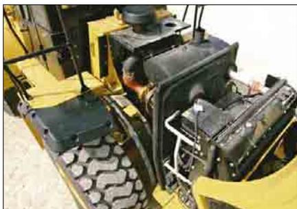
Il cofano può essere facilmente sollevato con un cilindro provvisto di sistema di emergenza meccanico. Il cofano sollevato consente un eccezionale accesso al motore e, se necessario, può essere totalmente rimosso, utilizzando i punti di sollevamento integrati.
