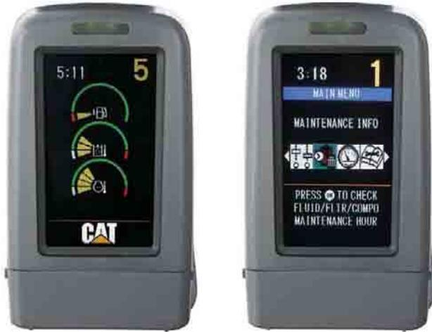
**Monitor.** Il monitor, a colori con cristalli liquidi, fornisce le informazioni sul funzionamento dei principali sistemi e spie d'allarme, con un semplice menù di navigazione.
