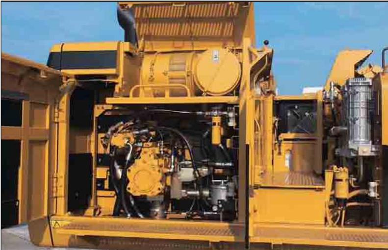
**Intervalli di manutenzione.** Gli intervalli di manutenzione sono stati estesi per ridurre i costi di manutenzione. Olio motore, filtri olio e combustibile ogni 500 ore.
