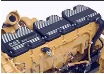
**Motore diesel.** Il motore CAT C18 da 18,1 litri a 6 cilindri, eroga 390 kW (530 hp) ed è dotato di iniettori ad attuazione meccanica e controllo elettronico (MEUI) nonché di albero a camme in testa.
