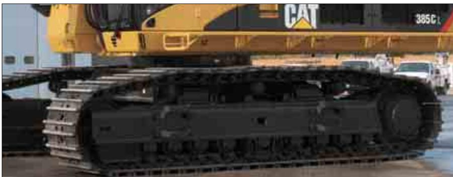
**Carro.** Il carro del 385C ha le catenarie lubrificate a grasso (GLT4). Le catenarie sono assemblate con grasso e sigillate per ridurre le usure e la rumorosità, a tutto vantaggio dei costi operativi.
