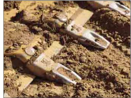
**Zahnschneidernanbau.** Die Zahnschneidern werden mit einer leichten Drehung um die Längsachse auf den Zahnhalter geschoben und mittels der elastischen einteiligen Sicherung zuverlässig befestigt.
