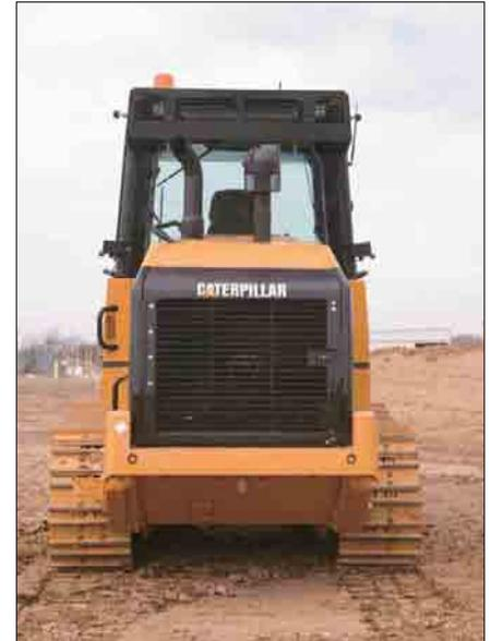
**Dieselmotoranordnung.** Aufgrund der Heckenanordnung übernimmt der Dieselmotor die Funktion eines Gegengewichts. Zugleich werden bei dieser Bauform die Sicht auf den vorderen Arbeitsbereich verbessert und die Wartungsarbeiten am Motor erleichtert.
