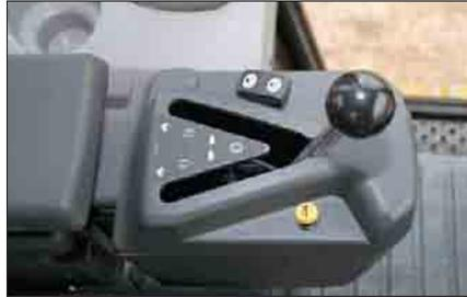
**Fahrgeschwindigkeit.** Mit den beiden wählbaren Einstellungen *Fahren* und *Arbeiten* lassen sich Fahrgeschwindigkeit und Drehmoment an die momentane Einsatzsituation anpassen, um die maximal mögliche Produktivität zu erzielen.
