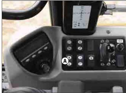
**Startanlage.** Mit dem elektronischen Drehzahl-Wahlschalter (A) in der rechten Konsole kann der Fahrer eine beliebige Motordrehzahl einsteuern. Beim Ingangsetzen der Maschine bewirkt das Motorsteuergerät ADEM A4, dass der Motor generell mit Leerlaufdrehzahl gestartet wird.
