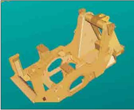
**Konstruktion.** Hauptrahmen und Hubrahmenkonsole bilden eine robuste, verwindungssteife Einheit, die über die notwendige Stabilität in typischen Kettenlader-Einsätzen bei starken mechanischen Beanspruchungen der gesamten Maschine verfügt.
