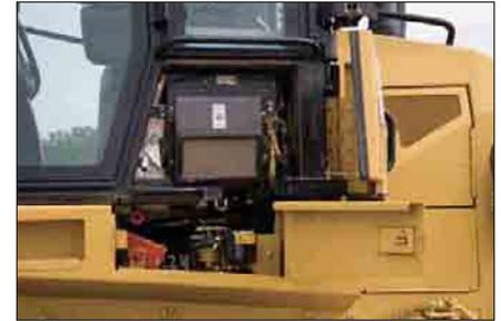
**Linke Kabinenseite.** Unterhalb des linken Fensters befinden sich Frischluftfilter, Minimessanschlüsse, Kabinenkippzylinder (falls vorhanden) und Hydraulikölfilter.
