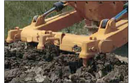
**Aufreißer.** Der Dreizahn-Radialaufreißer mit robuster Bolzenbefestigung an beiden Seiten des Maschinenhaupttrahmens macht den 963D zur echten Allround-Maschine. Zwei seitlich angeordnete Zylinder bewirken das Heben und Senken. Die sechs Bolzendrehgelenke sind wartungsfrei ausgeführt.
