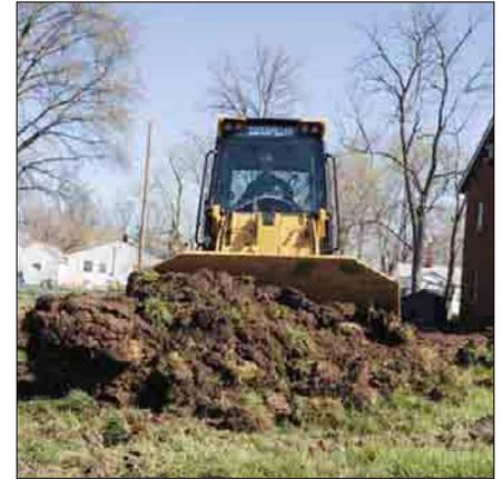
**Lenkung.** Mit dem rechten und linken Pedal wird die Maschine durch individuelles Ansteuern der beiden Laufketten feinfühlig gelenkt. Abhängig vom Betätigungsweg des jeweiligen Pedals fährt der 963D eine mehr oder weniger scharfe Kurve beziehungsweise dreht sich mit gegenläufig angetriebenen Ketten auf der Stelle.
