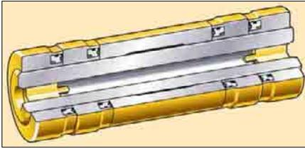
**Buchse-Bolzen-Einsätze.** Bereits im Werk werden Drehbuchse und Bolzen zu einer Einheit zusammengesetzt und anschließend verschweißt, um das Längsspiel zu minimieren. Spezialöl und neue, haltbarere Abdichtungen sorgen für maximale Standzeit bei völliger Wartungsfreiheit.
