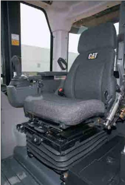
**Fahrersitz.** Im körpergerecht ausgepolsterten Caterpillar Komfortsitz mit Luftfederung, Lendenwirbelstütze und Sechswegen-Verstellung findet der Fahrer bei jedem Einsatz eine entspannte Arbeitshaltung. Der Automatiksicherheitsgurt besitzt 75 mm breite Gurtbänder. Optional ist eine Sitzheizung lieferbar.
