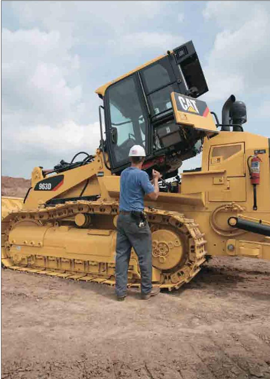
**Kabinenkippvorrichtung.** Eine erhebliche Erleichterung der Wartungs- und Reparaturarbeiten wird durch die kippbare Fahrerkabine erreicht, die in
