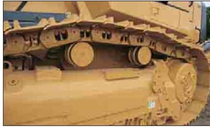
**Lauf- und Tragrollen.** Sieben Laufrollen an jeder Seite verteilen das Maschinengewicht auf eine große Aufstandsfläche. Das obere Kettentrum wird durch zwei Tragrollen abgestützt. Konstruktiv sind die Lauf- und Tragrollen an das neue SystemOne angepasst worden, um eine noch bessere Kettenführung zu erzielen. Im Gegensatz zu früher ist die Maschine ausschließlich mit Einflansch-Laufrollen bestückt, deren erhöhte Flansche die Führung der Ketten optimieren.
