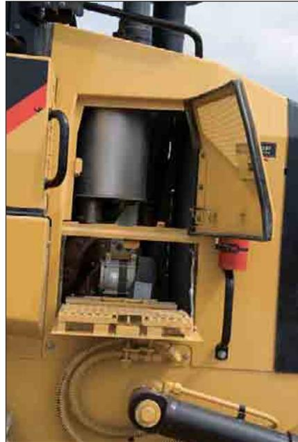
**Linke Maschinenseite.** Der untere Teil der Wartungsklappe an der linken Maschinenseite wurde als Trittstufe konstruiert. Von hier aus kann man nicht nur Kühlmittel-Ausgleichsbehälter und Ansaugluft-Vorreiniger direkt erreichen, sondern auch das Heckfenster mühelos reinigen.
