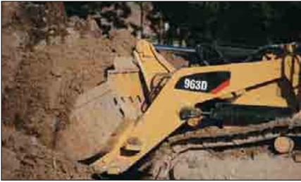
**Universalschaufel.** Die ideale Schaufel für einen breiten Anwendungsbereich, etwa bei Erdaushub und Bodenabtrag sowie beim Laden aus der Wand oder vom Haufwerk. Hochfeste, niedrig legierte Stahlbleche und schalenförmige Verstärkungen an der Rückseite bieten eine exzellente Stoß- und Verschleißfestigkeit.
