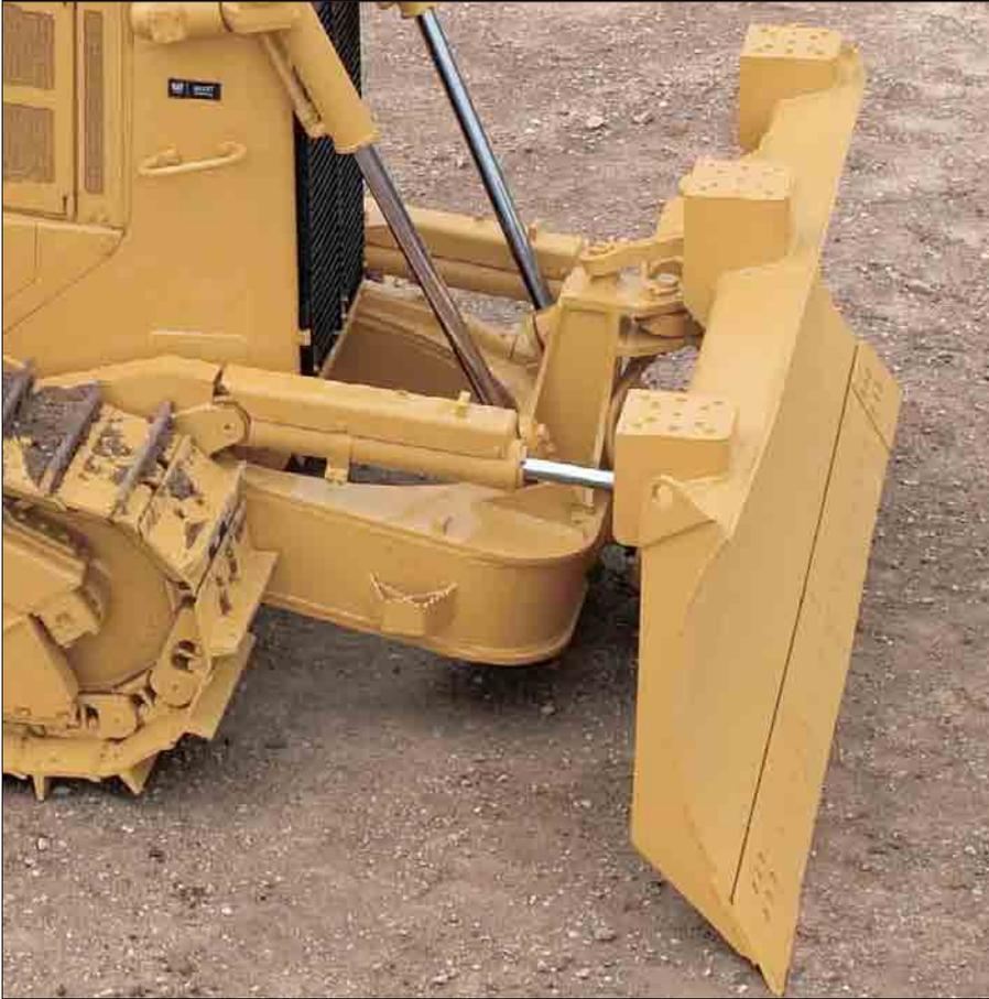
**Planierschilde.** Als besonderes Merkmal ist die stabile Kastenprofil-Bauweise hervorzuheben, die den Planierschilden die erforderliche Robustheit verleiht. Der Schildkörper wird komplett aus Cat DH-2™-Stahl mit hoher Zug- und Abriebfestigkeit hergestellt. Hinzu kommen durchgehärtete und daher besonders langlebige Schneidwerkzeuge in unterschiedlichen Ausführungen.
