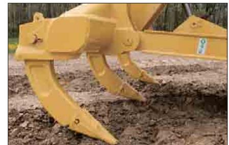
**Mehrzahn-Aufreißer.** Dieser Aufreißertyp mit Parallelogrammaufhängung bietet optimale Anpassungsmöglichkeiten an das zu reißende Material durch den wahlweisen Einsatz von ein, zwei oder drei Zähnen. Darüber hinaus sind die Reißzähne in gerader und gebogener Ausführung lieferbar.
