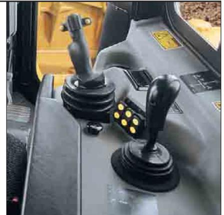
**Schildsteuerhebel.** Mit dem leichtgängigen, ergonomisch geformten Steuerhebel lässt sich der Schild feinfühlig und ermüdungsarm positionieren, denn das Hydrauliksystem ist serienmäßig mit einer hydraulischen Vorsteuerung ausgerüstet. Beim VPAT-Schild kann der Fahrer den Schwenkwinkel per Daumendruck ansteuern. Maschinen mit AccuGrade®-Vorrüstung erhalten ab Werk eine elektrohydraulische Vorsteuerung.
