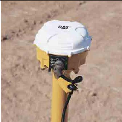
**AccuGrade GPS.** AccuGrade GPS nutzt die Satelliten des globalen Ortungssystems, um die Lage des Planierschilds relativ zur Geländeoberfläche in der Fahrerkabine anzuzeigen. Mithilfe verschiedener maschinenmontierter Komponenten und einer GPS-Basisstation erfolgt eine zentimetergenaue Darstellung des Schilds in Echtzeit.
