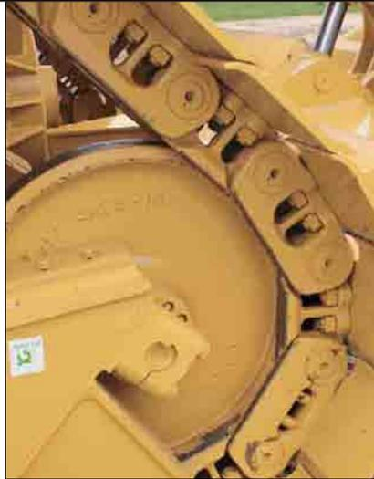
**SystemOne-Leiträder.** Bei SystemOne-Leiträdern lässt sich der Außenumfang über die gesamte Breite als Lauffläche nutzen, weil kein Mittelflansch mehr erforderlich ist. In Verbindung mit den erhöhten Laufrollenflanschen wird dadurch eine wesentlich bessere Kettenführung bewirkt und zugleich die typische wellenförmige Abnutzung der Kettenglied-Laufflächen unterbunden. In den meisten Einsätzen verlängern SystemOne-Leiträder die Lebensdauer des gesamten Laufwerks um 50% oder mehr.
