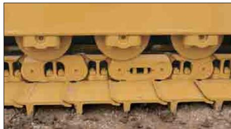
**SystemOne-Laufrollen.** Die höheren Flansche der SystemOne-Laufrollen sorgen für eine bessere Kettenführung, die sich besonders beim Arbeiten in seitlicher Schräglage vorteilhaft bemerkbar macht. Optimierte Konstruktion und weniger Einzelteile verhelfen den Laufrollen zu größerer Stabilität, die u.a. eine bessere Langzeitdichtigkeit garantiert. Um eine ausgewogene Abnutzung sicherzustellen, wurde auch das Verschleißverhalten der Tragrollen entsprechend angepasst.
