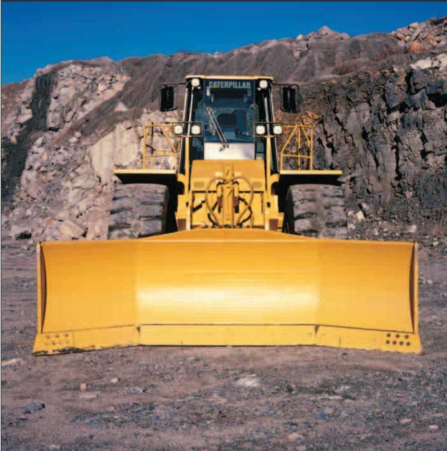
**Schildsteuerung.** Zur Standardausrüstung gehören Hub-, Kipp- und Neigehydraulikkreise, die durch die neue Schildsteuerautomatik ABP ergänzt werden.
