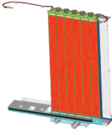
**Modul-Wasserkühler.** Der Modul-Wasserkühler besteht aus sechs besonders rüttelfesten Parallelstrom-Teilblöcken, die sich leicht einzeln aus- und einbauen lassen, weil kein oberer Wasserkasten vorhanden ist. Aufgrund des großen Lamellenabstands werden Verstopfungen weitgehend vermieden.
