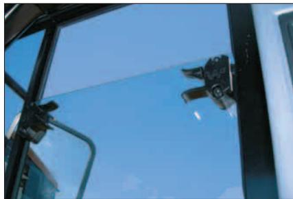
**Schiebefenster.** Optional können beiden Türen der Fahrerkabine mit einem Schiebefenster ausgestattet werden, die bei Bedarf eine wirksame Belüftung des Innenraums ermöglichen.
