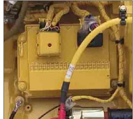
**Motorsteuergerät ADEM™ A4.** Das elektronische Steuergerät ADEM A4 übernimmt Regelung und Koordination von Einspritzung und Ansaugluftmenge, um die spezifische Leistung des Motors bei jedem Lastzustand zu optimieren. Dank der variablen Kennfeldsteuerung ist eine spontane Anpassung an wechselnde Betriebsituationen möglich.
