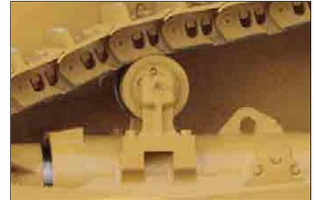
**Tragrollenhalterung.** Die Halterung der Tragrolle ist aus einem Stück mit dem Laufrollenrahmen gegossen. Dadurch wird das Anbauen der Tragrolle wesentlich erleichtert, wenn es die Einsatzbedingungen erfordern.
