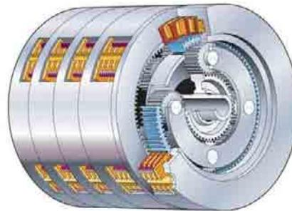
**Differenzialwandler.** Die hohe Drehmomentsteigerung im Wandler des hydrodynamischen Fahrtriebs sorgt für exzellentes Durchzugsvermögen bei maximaler Last am Schild oder Aufreißer. Zugleich schützt die stoßdämpfende Wirkung des Wandlers den gesamten Antriebstrang vor übermäßiger Beanspruchung.
