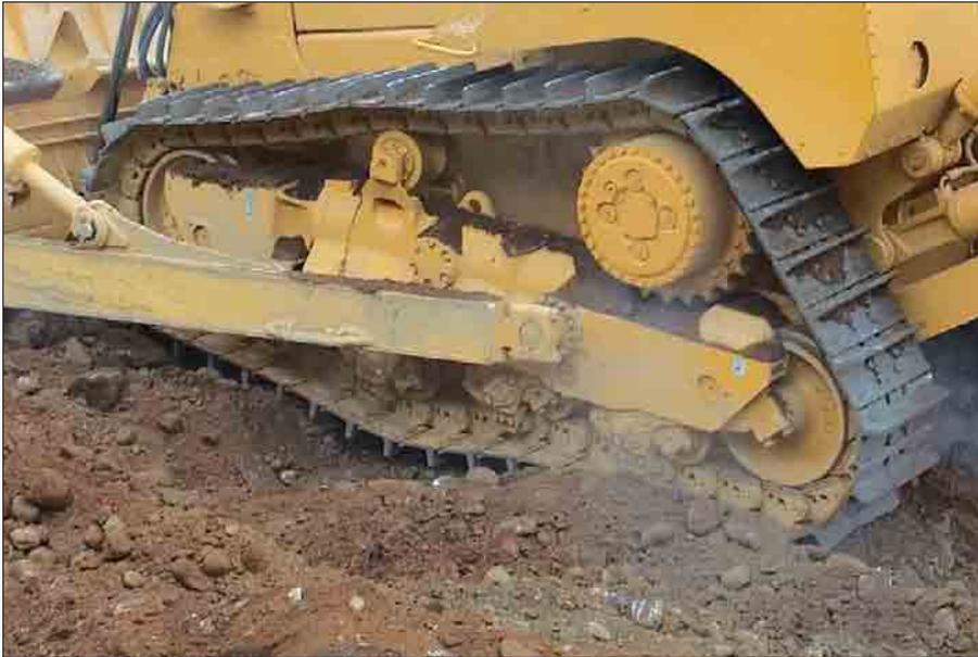
**Pendelgestelle.** Die Pendelgestelle des Delta-Laufwerks verringern die Stoßbelastung des Laufwerks auf rauem Untergrund um bis zu 50%.
