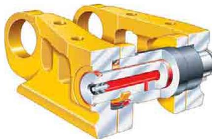
**Laufketten.** Der D8T besitzt serienmäßig ölgeschmierte Ketten mit Bolzensicherung, die auch bei extremen Stoßbelastungen für festen Sitz der Kettenbolzen in den Kettengliedbohrungen sorgt.
