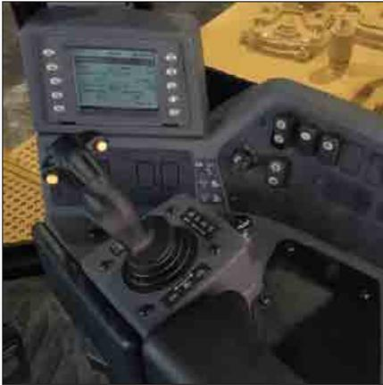
**Schildsteuerhebel.** Weil der Steuerhebel lediglich elektrische Signale erzeugt, lässt er sich mit minimalem Kraftaufwand betätigen. Durch Längsbewegungen des Hebels wird der Schild proportional angehoben bzw. abgesenkt, während Querbewegungen das Kippen des Schilds nach links/rechts bewirken. Mit der Daumentaste auf der Hebeloberseite wird der Neigungswinkel verändert, der Kippschalter erlaubt den schnellen Wechsel zwischen Ein- und Zweizylinderbetrieb.
