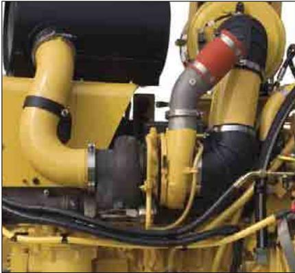
**Ansaugsystem.** Abgasturbolader und luftgekühlter Ladeluftkühler sorgen nicht nur für hohe Leistung und schnelles Ansprechen, sondern senken auch die Ansauglufttemperatur, sodass sich die Standzeit des Motors verlängert.
