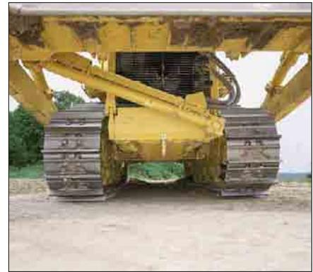
**Konstruktion.** Die aufwendige Kastenprofilkonstruktion des Hauptrahmens sorgt unter allen Betriebsbedingungen für höchste Verdreh- und Biegesteifigkeit.
