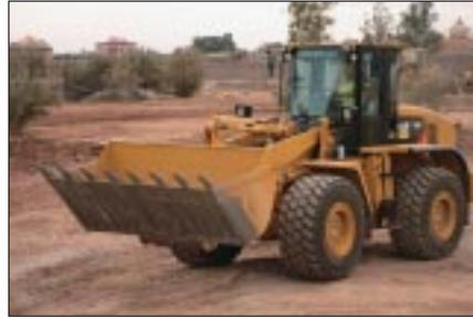
**Konstantleistung.** Das elektronische Steuergerät mit Kennfeldtechnik bewirkt, dass der Cat Dieselmotor C6.6 innerhalb eines breiten Drehzahlbereichs eine konstante Leistung abgibt. Wechselnde parasitäre Lasten, die zum Beispiel durch den temperaturgesteuerten Lüfter oder die Klimaanlage auftreten, werden vollständig kompensiert.
