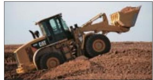
**Schwingungsdämpfung.** Die hydraulische Schwingungsdämpfung RC (Ride Control) minimiert die für Radlader typischen Nickschwingungen. So fährt die Maschine nicht nur wesentlich sicherer, sondern zugleich werden schädliches Reifenwalken und Materialüberlauf deutlich reduziert. Bei Geschwindigkeiten unter 10 km/h schaltet sich das System automatisch ab, um die Ladeleistung nicht zu beeinträchtigen.
