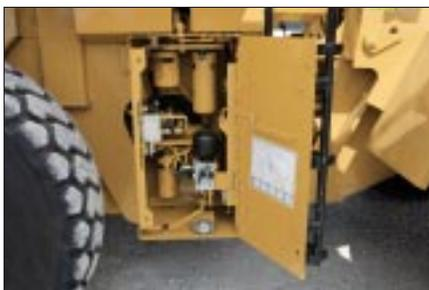
**Hydraulik-Servicezentrum.** Getriebeöl- und Hydraulikölfilter wurden in einem Hydraulik-Servicezentrum hinter der ausklappbaren rechten Leiter zusammengefasst. Von dieser Stelle aus kann auch der Hydrauliköltank entleert werden.
