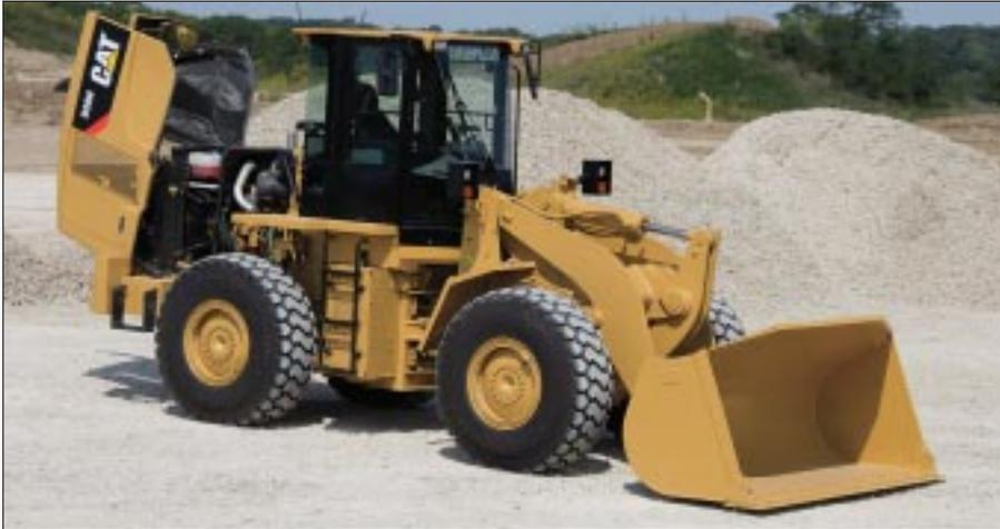
**Motorraumzugang.** Eine elektrohydraulische Kippvorrichtung mit mechanischer Notbetätigung erlaubt ein schnelles Öffnen der Motorhaube, damit Dieselmotor, Nebenaggregate und Kühlerraum bei Bedarf frei zugänglich sind. Durch die seitliche Wartungsklappe kommt man direkt an Motoröl-
