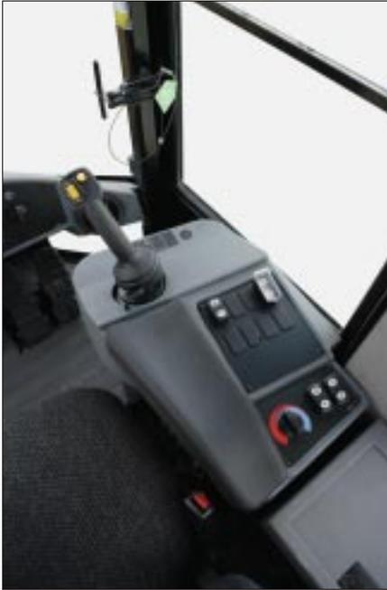
**Joystickkonsole.** Auf der vollständig neu gestalteten Konsole mit langer, verstellbarer Armauflage ist der handliche Joystick angeordnet, der ein ermüdungsarmes, feinfühliges Ansteuern der Hub- und Kipphydraulikkreise ermöglicht. Im Knauf des Joysticks befinden sich daumenbetätigte Schalter für Fahrtrichtungswechsel, Kickdown-Funktion und Signal-/Warnhorn.
