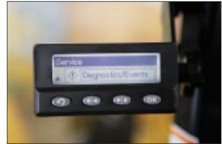
**Cat Messenger.** Auf dem Display des Cat Messenger werden Rückmeldungen über die Betriebszustände von Dieselmotor und Maschine in Echtzeit visualisiert. Mithilfe der eingeblendeten Diagnosecodes sowie Wartungs- und Systemparameter sind vorliegende Störungen erheblich schneller zu beseitigen.
