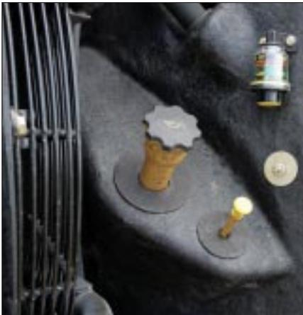
Messstab, Kühlmittel-Schauglas und Luftfilter-Wartungsanzeiger heran, ohne die Motorhaube hochkippen zu müssen.
