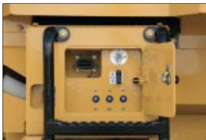
**Elektrik-Servicezentrum.** Fremdstartanschluss, Batterie Hauptschalter, Sicherungen und Motorhauben-Kippschalter befinden sich bestens erreichbar in einem abschließbaren Raum unter der linken Zugangsplattform. Die wartungsfreien Starterbatterien sind gut erreichbar direkt unter dem Elektrik-Servicezentrum platziert.
