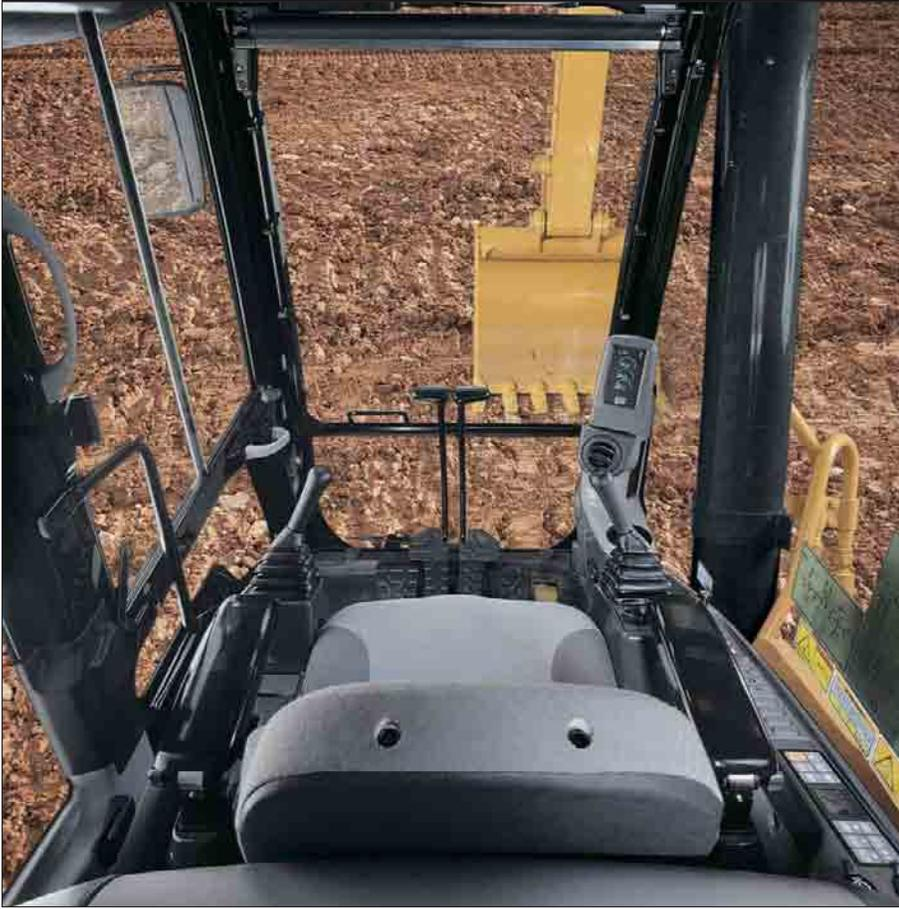
**Ergonomie.** Im Innenraum der Kabine dominieren Ergonomie und Komfort. Alle Bedienelemente befinden sich in direkter Reichweite und lassen sich mit wenig Kraftaufwand betätigen. Das neue Steuer- und Überwachungspult ist im Blickfeld des Fahrers angeordnet, ohne die Sicht zu behindern.
