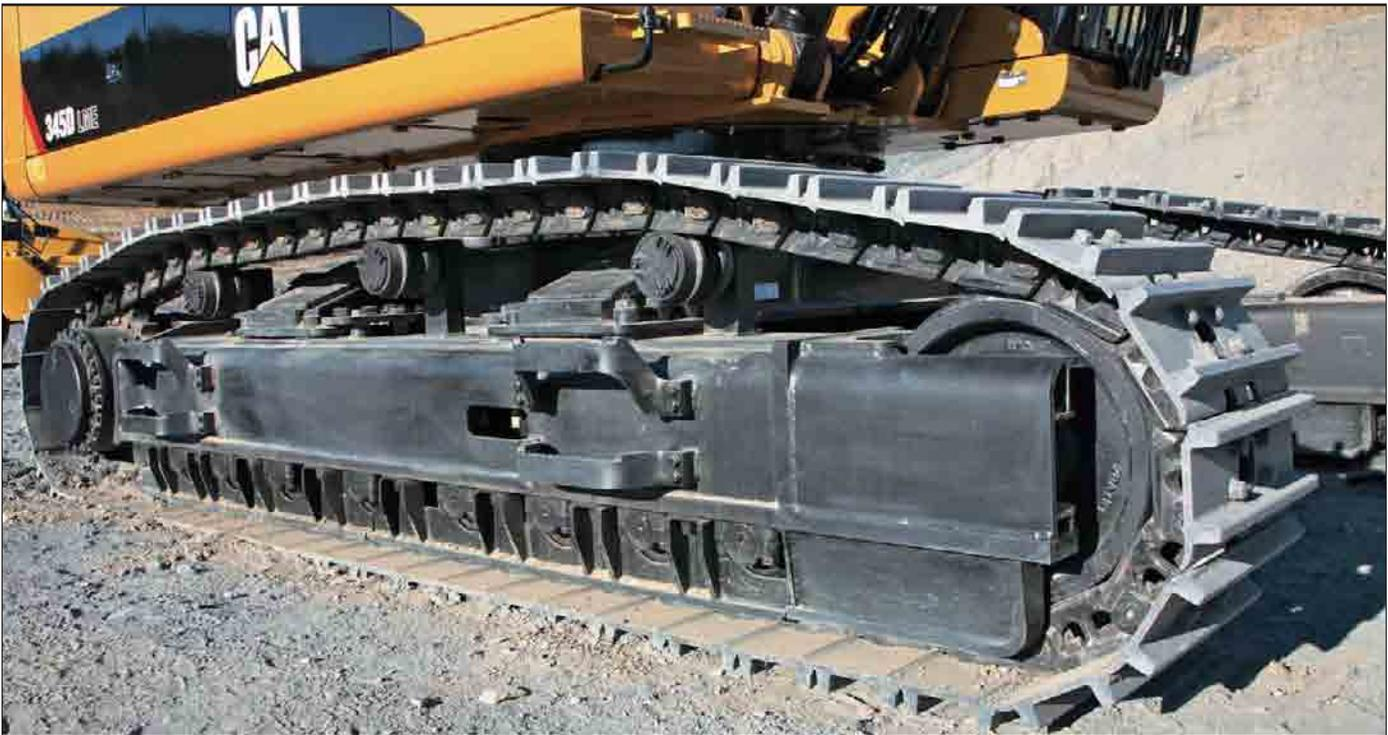
**Laufwerksoptionen.** Zur Standardausrüstung gehören Ketten mit Fettschmierung, die sich durch einen reduzierten Innenverschleiß auszeichnen und die Nutzungsdauer des gesamten Laufwerks wesentlich verlängern. Außerdem werden die lästigen Quietschgeräusche beim Umsetzen der Maschine verringert.
