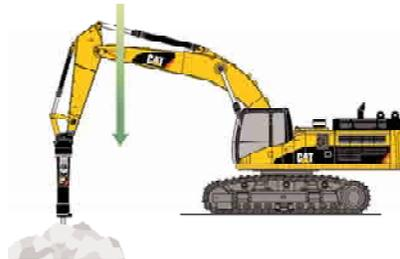
**Hammerarbeiten.** Bei Nutzung der Schwimmfunktion dringt der Hammer bereits durch das Eigengewicht der Arbeitsausrüstung ohne zusätzliche Druckansteuerung in das Brechgut ein. So werden Fahrer und Maschine geschont und schädliche Hammerleerschläge vermieden. Ähnliche Vorteile ergeben sich beim Arbeiten mit Verdichterplatten.
