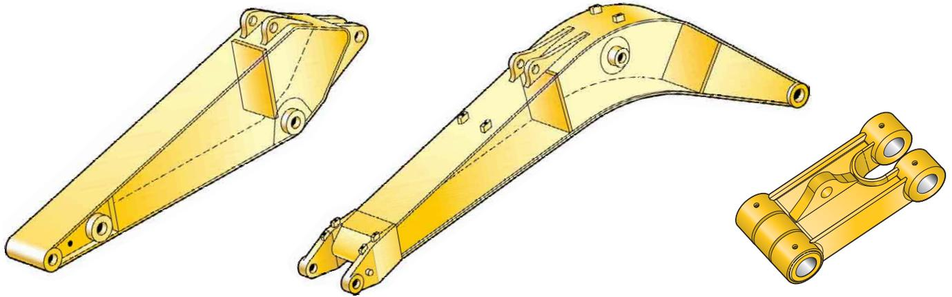
**Auswahl.** Um bei jedem Einsatz die höchstmögliche Produktivität zu erzielen, kommt es auf die richtige Auswahl der Arbeitsausrüstung an. Zwei Ausleger und vier Stiele erlauben eine enge Abstimmung der Maschine auf unterschiedlichste Aufgabenstellungen. Alle Cat Ausleger und Stiele werden spannungsarm gegläht, um die maximale Lebensdauer zu erreichen.
