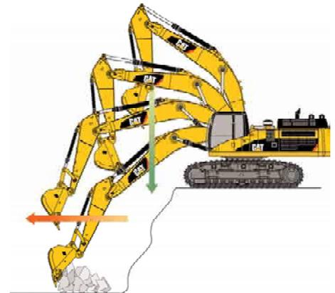
**LKW-Beladung.** LKWs/SKWs lassen sich von einer erhöhten Standebene aus produktiver und kraftstoffsparender beladen, weil sich der Ausleger während des Rückschwenkens durch sein Eigengewicht absenkt.
