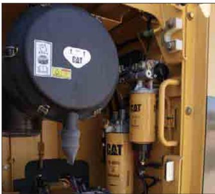
**Serviceintervalle.** Verlängerte Wartungsintervalle reduzieren den Zeit- und Kostenaufwand. Motoröl, Motorölfilter und Kraftstofffilter sind nur noch alle 500 Stunden zu wechseln. Die Wechselintervalle des Hydrauliköls können bei normalen Maschineneinsätzen auf bis zu 2000 h ausgedehnt werden, sofern es die Ergebnisse der regelmäßigen Ölproben-Untersuchungen im Zeppelin Labor zulassen.
