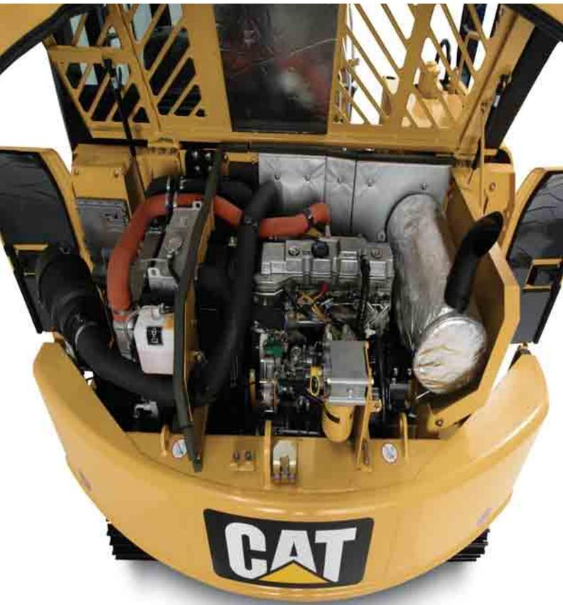
Caterpillar Hydraulikbagger sind nicht nur äußerst robust, sondern auch ausgesprochen servicefreundlich gebaut, denn der guten Zugänglichkeit aller Komponenten wird bereits in der Entwicklungsphase größte Aufmerksamkeit gewidmet. Alle täglichen Wartungsarbeiten lassen sich nach Öffnen der Motorhaube und Seitenklappen mühelos durchführen. Zapfventile gestatten die saubere Entnahme von Betriebsstoffproben zur Untersuchung im Zeppelin Labor.
