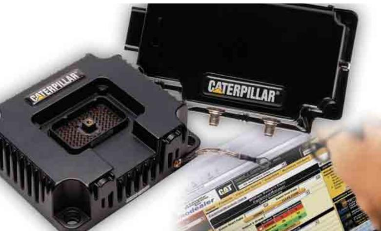
Das satellitengestützte Cat Ortungs- und Datenerfassungssystem Product Link stellt per Internet und Cat Software Equipment-Manager eine dialogfähige Verbindung zwischen den Bordsystemen der Maschine und dem Bürocomputer des Betreibers her. Product Link bietet einen beeindruckenden Funktionsumfang:
