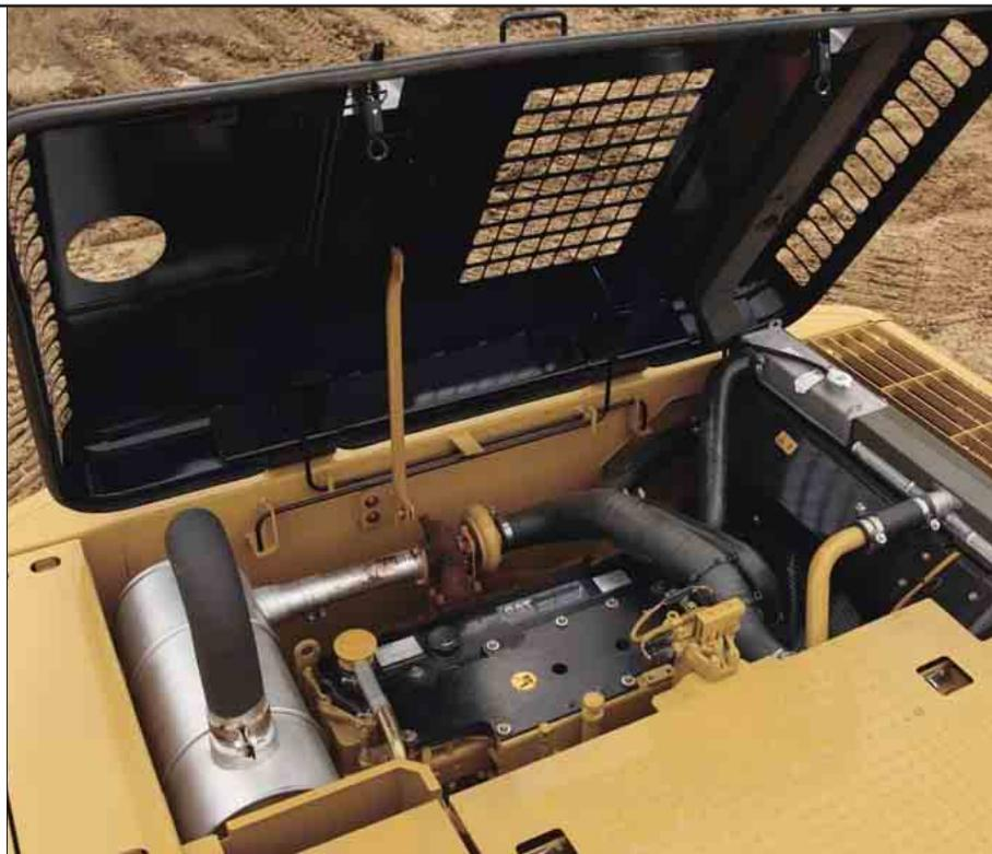
**Sensoren.** Eine wesentliche Funktion des elektronischen Steuergeräts besteht darin, die Motorparameter umgehend an wechselnde Einsatzbedingungen anzupassen, um Wirtschaftlichkeit und Umweltverträglichkeit jederzeit zu optimieren. Für diesen Zweck setzt das Steuergerät die Signale der Sensoren im Ansaug-, Abgas-, Kraftstoff- und Kühlsystem entsprechend um. Darüber hinaus werden wichtige Diagnoseinformationen gespeichert.
