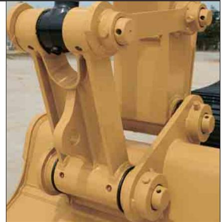
**Löffel-Umlenkmechanismus.** Die neue Koppel des Löffel-Umlenkmechanismus steigert die Tragfähigkeit der Maschine und ist dank der integrierten Lastöse einfacher zu handhaben als die frühere Ausführung. Zudem liegt der Lastanschlagpunkt jetzt tiefer, sodass sich die Kraft der Hubzylinder optimal nutzen lässt.
