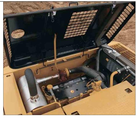
Motorsteuergerät ADEM™ A4. Das elektronische Steuergerät ADEM™ A4 übernimmt Regelung und Koordination von Einspritzung und Ansaugluftmenge, um die spezifische Leistung des Motors bei jedem Lastzustand zu optimieren. Aufgrund der variablen Kennfeldsteuerung ist eine sofortige Anpassung an wechselnde Betriebssituationen möglich.
