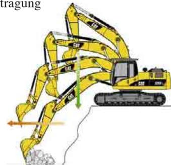
**LKW-Beladung.** LKWs/SKWs lassen sich von einer erhöhten Standebene aus produktiver und kraftstoffsparender beladen, weil sich der Ausleger durch sein Eigengewicht absenkt.
