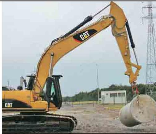
**Schwerlast-Hubfunktion.** Mit der serienmäßigen Schwerlast-Hubfunktion lässt sich per Tastendruck die Tragfähigkeit bei Hebeinsätzen erhöhen und zugleich die Feinsteuerung verbessern.
