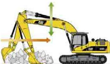
**Steinschürfen/Feinplanieren.** Arbeiten wie Steinschürfen und Feinplanieren werden durch SmartBoom wesentlich erleichtert, denn der Ausleger kann der Bodenkontur frei folgen.
