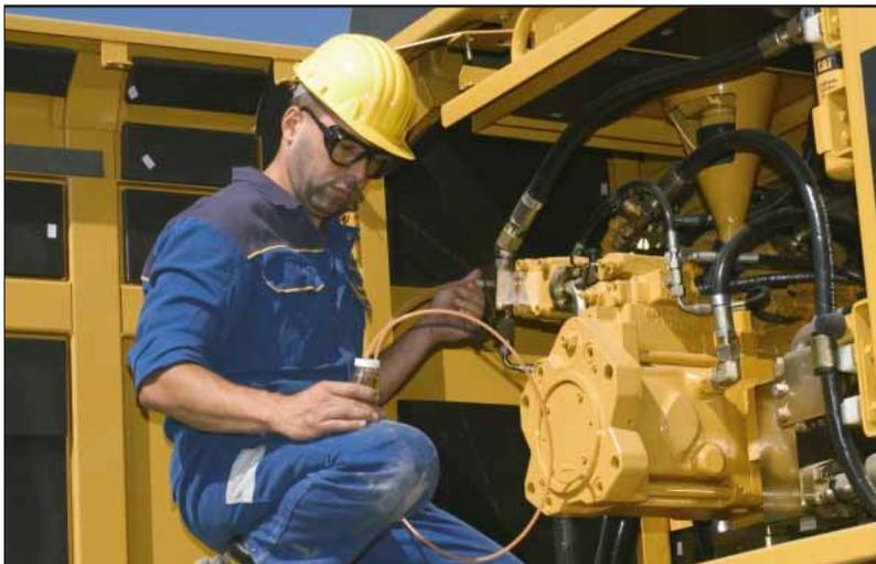
**Serviceintervalle.** Verlängerte Wartungsintervalle reduzieren den Zeit- und Kostenaufwand. Motoröl, Motorölfilter und Kraftstofffilter sind nur noch alle 500 Stunden zu wechseln.
