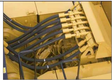
**Steuerung.** Lastgeregelte Arbeits- und Fahrhydraulik mit proportionaler Durchflussverteilung und elektronischer Betätigung bieten eine hervorragende Energiebilanz und feinfühligste Ansteuerung aller Funktionen:
