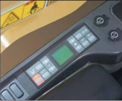
**Steuerhebelkonsolen.** Beide Steuerhebelkonsolen wurden neu gestaltet, um die Funktionalität zu verbessern und dem Fahrer ein ermüdungsarmes, produktives Arbeiten zu ermöglichen. Die in der Höhe verstellbaren Armlehnen sind direkt mit den Konsolen verbunden.
