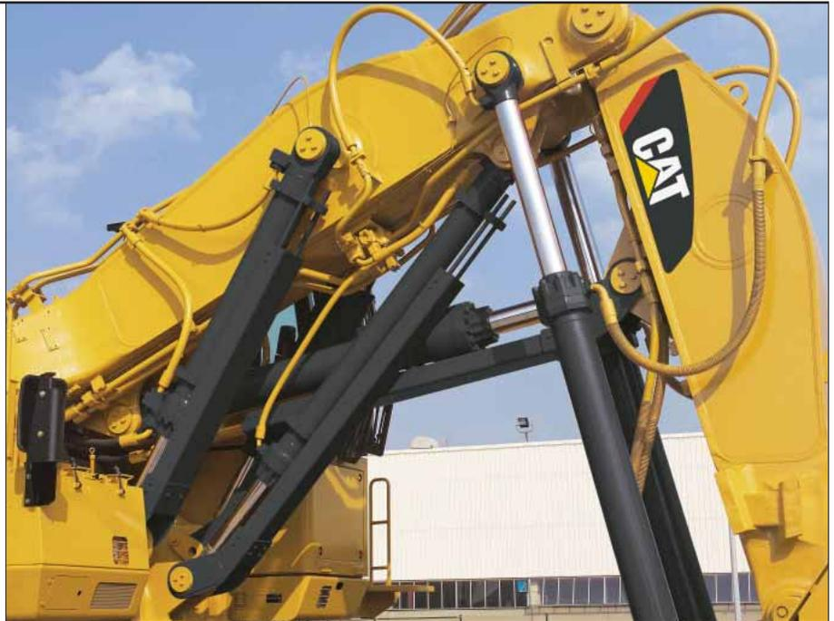
**Gelenkbolzen.** Sämtliche Bolzen in den Ausleger- und Stielgelenken sind mit einer dicken Chromschicht überzogen, die eine hohe Verschleiß- und Korrosionsfestigkeit bewirkt. Die Durchmesser der Bolzen wurden so groß wie möglich gewählt, um die beim Graben und Heben auftretenden Scher- und Biegekräfte gleichmäßig zu verteilen.
