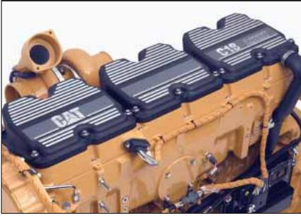
**ACERT-Konzept.** Der Cat Sechszylinder-Dieselmotor C18 mit 18,1 l Hubraum, elektronischer Einspritzung und obenliegender Nockenwelle gibt im 385C FS eine Nennleistung (ISO 9249) von 390 kW (530 PS) ab. Bei der Entwicklung des Motors kam das zukunftsorientierte ACERT-Konzept zur Anwendung, das auf eine Optimierung der Kraftstoffverbrennung abzielt und eine drastische Schadstoffminderung bewirkt.
