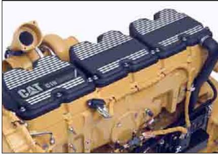
**ACERT-Konzept.** Der Cat Sechszylinder-Dieselmotor C18 mit 18,1 Liter Hubraum, elektronischer Hochdruck-Direkteinspritzung und oberliegender Nockenwelle gibt eine Nennleistung (ISO 9249) von 390 kW (530 PS) ab. Bei der Entwicklung des Motors kam das zukunftsorientierte ACERT-Konzept zur Anwendung, das auf eine Optimierung der Kraftstoffverbrennung abzielt und eine drastische Schadstoffminderung bewirkt.
