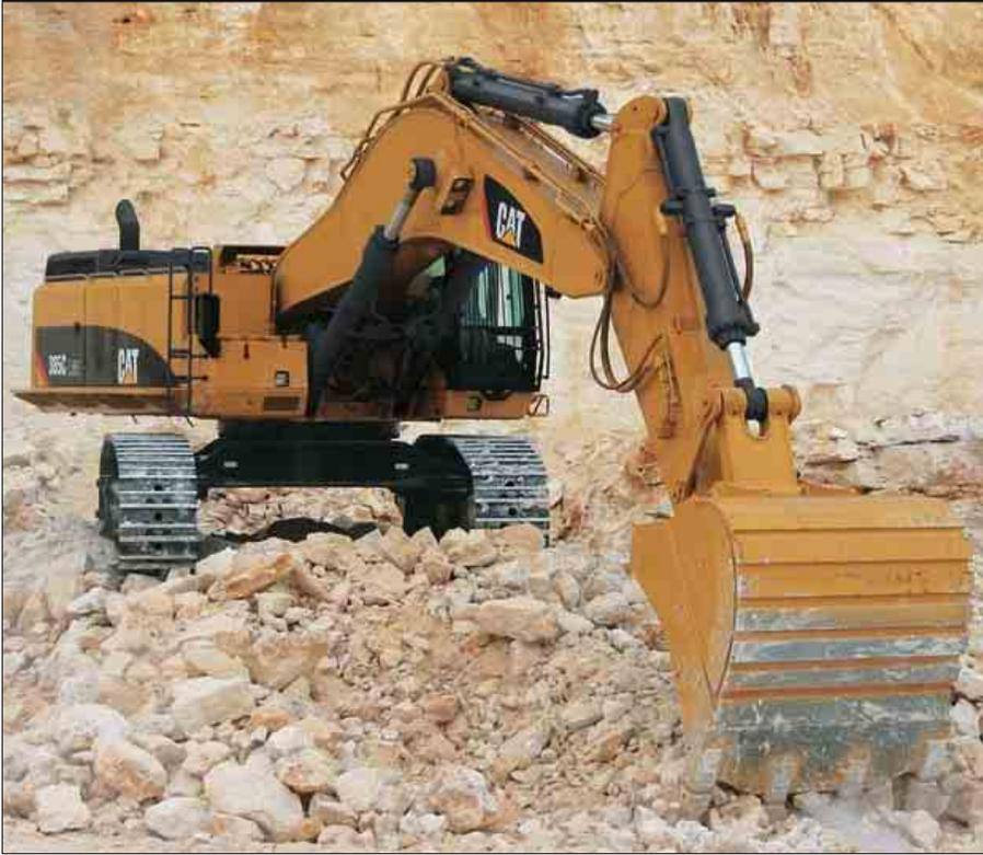
**Bauteile.** Alle Bauteile des stark dimensionierten Laufwerks werden von Caterpillar selbst konstruiert und hergestellt, sodass die Komponenten in Bezug auf Werkstoffauswahl und Härtegrad optimal aufeinander abgestimmt sind.
