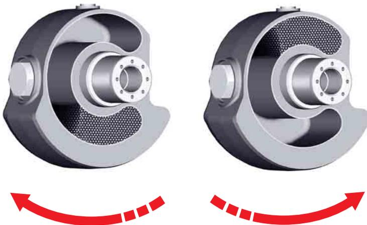
**Amplitudenwahl.** Mit einem Schalter in der Kabine kann der Fahrer je nach Aufgabenstellung bequem die große oder kleine Vibrationsamplitude wählen.
