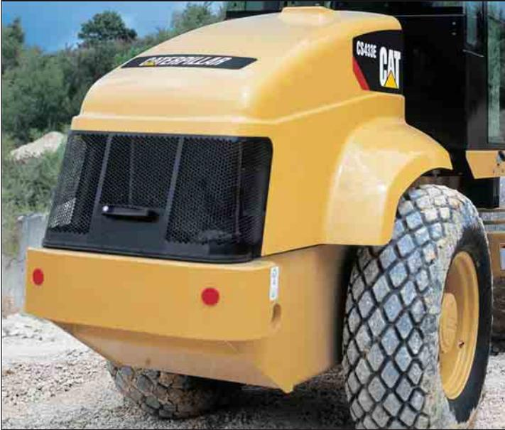
**Sichtverbesserung.** Aufgrund der starken Abschrägung der attraktiv gestalteten Motorhaube wird die Sicht auf die Hinterräder erheblich verbessert. Gleichzeitig reduzieren sich Höhe und Länge des toten Winkels im Rückraum auf nur noch einen Meter. So lassen sich die Maschinen in der Nähe von Hindernissen erheblich sicherer manövrieren.
