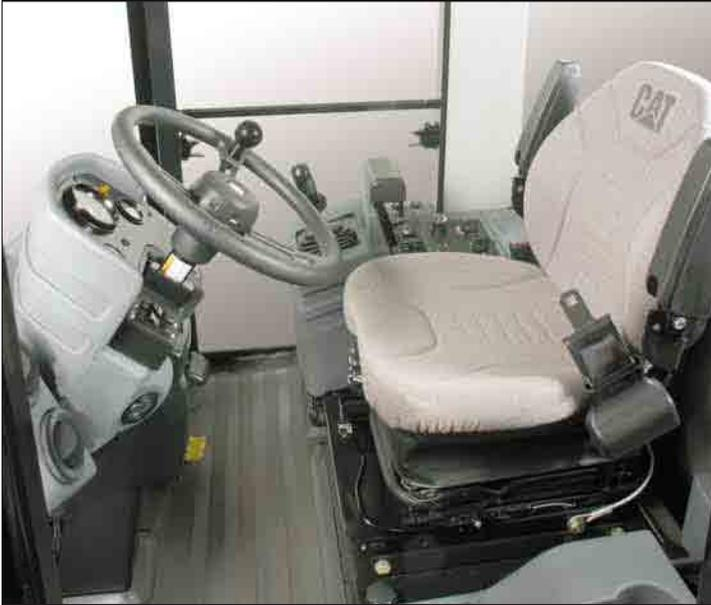
**Instrumente.** Die im Blickfeld des Fahrers angeordnete Instrumentenkonsolle lässt sich zusammen mit der Lenksäule stufenlos verstellen. Dadurch wird das Ein- und Aussteigen erleichtert und eine individuelle Anpassung ermöglicht.
