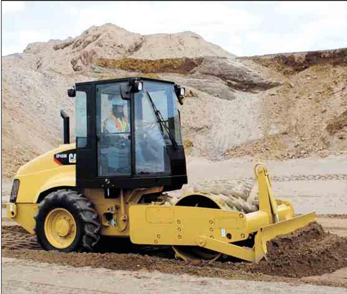
**Anwendung.** Bei Ausrüstung mit dem optionalen Planierschild lassen sich CP433E und CS433E erheblich vielseitiger einsetzen, denn sie können zusätzliche Aufgaben übernehmen – beispielsweise Materialeinbau, Grabenrückverfüllung, Bauwerkhinterfüllung und leichte Planierarbeiten.
