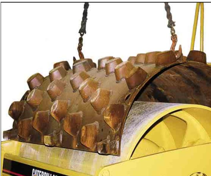
**Ausführung.** Die anschraubbaren Stampffußschalen besitzen insgesamt 84 Stampffüße mit 90 mm Höhe. Jede der beiden Schalen wiegt 453 kg.
