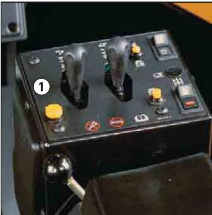
**1 Commandes d'équipement électro-hydrauliques.** Augmente l'efficacité hydraulique et améliore le confort de conduite grâce aux commandes du bout des doigts requérant un minimum d'effort. Les flexibles XT-3™ et XT-5™ ainsi que les pièces connexes d'une grande fiabilité réduisent les risques de fuites et de ruptures de flexibles, contribuant ainsi à la protection de l'environnement.
