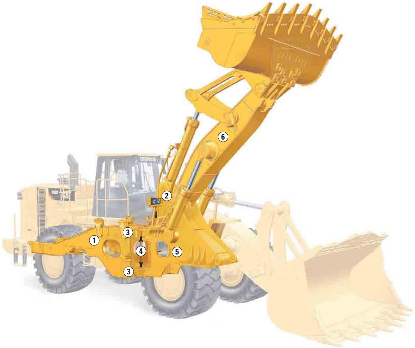
**Structures.** Font appel aux soudures par robot et à des pièces moulées dans les zones sensibles soumises à de fortes contraintes. Plus de 90% des soudures de la 988H sont réalisées par robot afin d'obtenir une grande homogénéité et une solidité hors du commun. Des pièces moulées sont également utilisées en plusieurs endroits pour accroître la robustesse en contribuant à répartir les charges et à réduire le nombre de pièces.
