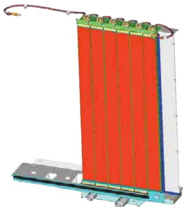
**Radiateur modulaire nouvelle génération (NGMR).** Améliore les caractéristiques de refroidissement grâce au système de débit parallèle à six faisceaux. L'entretien du radiateur NGMR est plus facile en l'absence d'un réservoir supérieur.
