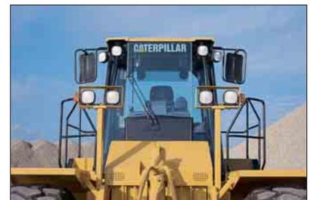
**Projecteurs.** Montés à l'extérieur du 824H, ils offrent une résistance exceptionnelle et une longévité jusqu'à sept fois supérieure à celle des anciens projecteurs. Un ensemble d'éclairage auxiliaire comprenant quatre projecteurs (deux orientés vers l'avant et deux orientés vers l'arrière) est disponible sur la cabine.
