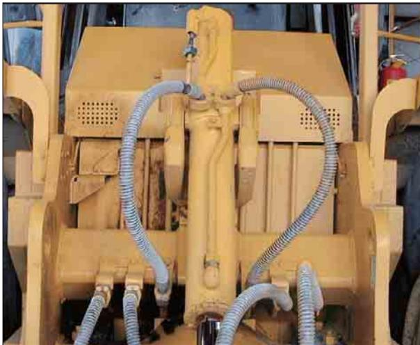
**Circuit hydraulique.** Procure une commande sans effort de la lame. Les leviers montés à même le siège transmettent des signaux électriques à une soupape pilote montée sur le châssis avant, éloignant ainsi du poste de conduite le bruit et la chaleur produits par un distributeur hydraulique.
