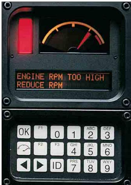
**Clavier.** Le clavier permet au conducteur ou au technicien d'accéder immédiatement aux informations actuelles de la machine, aux niveaux des instruments et aux données stockées, via l'écran de la centrale d'affichage.
