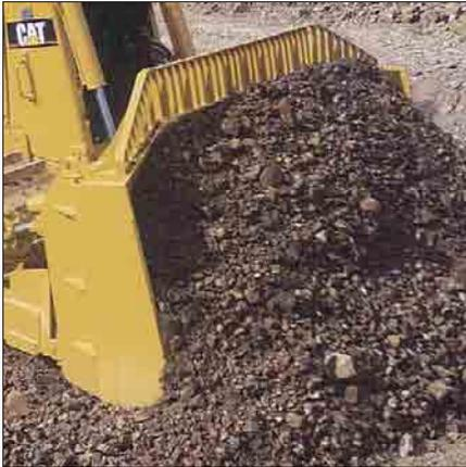
**Bulldozers.** La conception caissonnée des lames leur confère une grande résistance aux forces de torsion et à la fissuration. Les lames sont réalisées en acier DH-2™ à haute résistance à la traction, pouvant supporter les applications les plus dures. Le bouclier robuste ainsi que les lames de coupe et les embouts trempés offrent un surcroît de solidité et de longévité.
