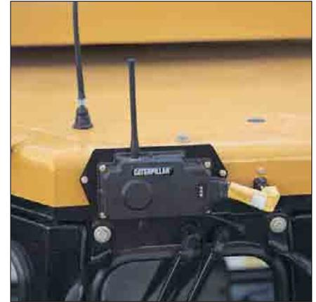
Ses répercussions sur la qualité du travail et sur la productivité totale sont largement avérées. Le D8T peut être commandé avec l'option prééquipement CAES de sorte que le câblage et les supports nécessaires au montage du système CAES préexistent.
