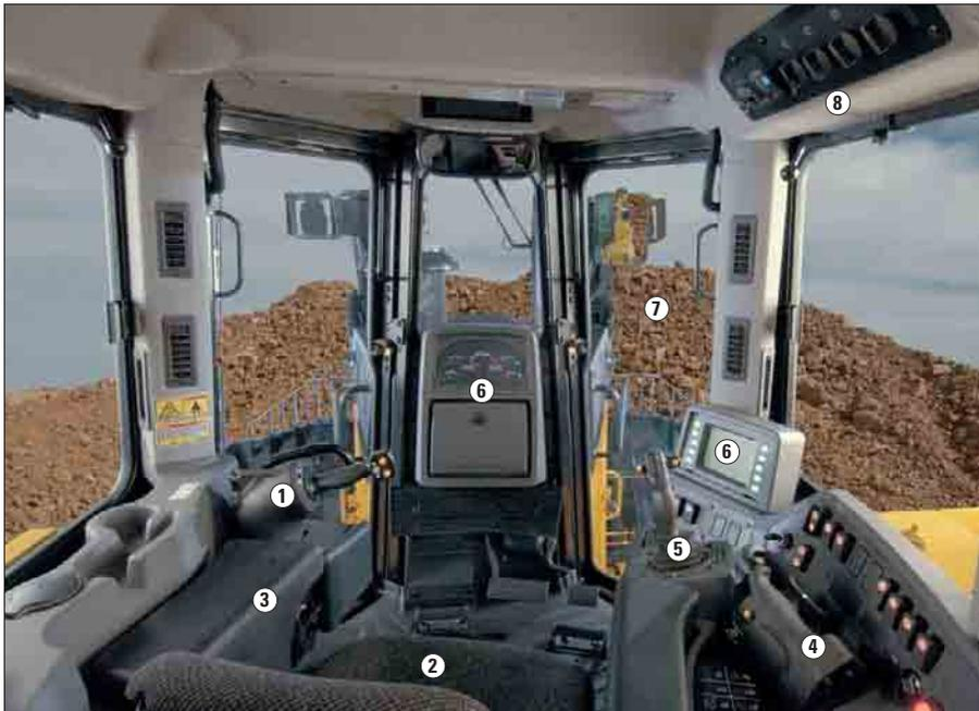
**1) Commande de direction.** La double poignée tournante, portant les commandes standard de direction différentielle, commande le sens et l'amplitude des braquages, le sens de marche et le passage des rapports au moyen d'une seule poignée, pour un plus grand confort de conduite.
