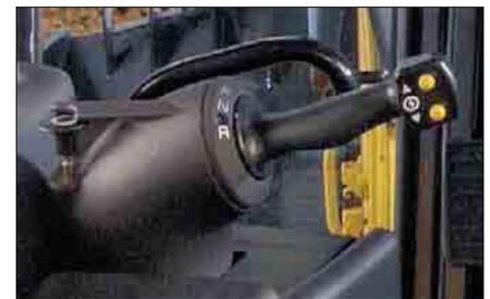
**Levier de commande de ripper.** Poignée montée rigide garantissant une commande sûre et précise du ripper, même sur les terrains les plus accidentés. Levier actionnable au pouce commandant sans effort le relevage et l'abaissement. Levier ne requérant qu'un minimum d'effort pour rentrer ou sortir la dent de ripper. Le bouton-poussoir relève automatiquement le ripper.
